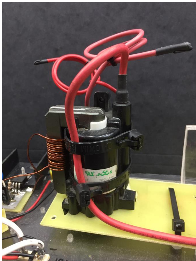
Εικόνα 2.3(ε): ο Μετασχηματιστής Flyback
