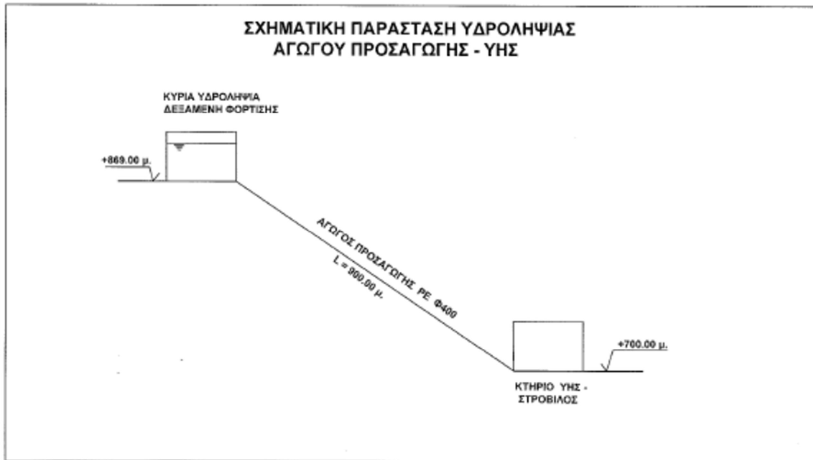
Σχήμα 0.1 Σχηματική παράσταση λειτουργίας ΜΥΗΕ Μικροσπηλιάς (Πηγή: Εταιρεία ΑΤΕΡΜΩΝ ΙΚΕ)
