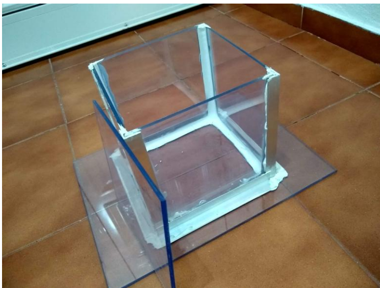
Εικόνα 14: Δεξαμενή Ηλεκτρόλυσης με διάφανο plexiglass για τον σκοπό της επίδειξης
