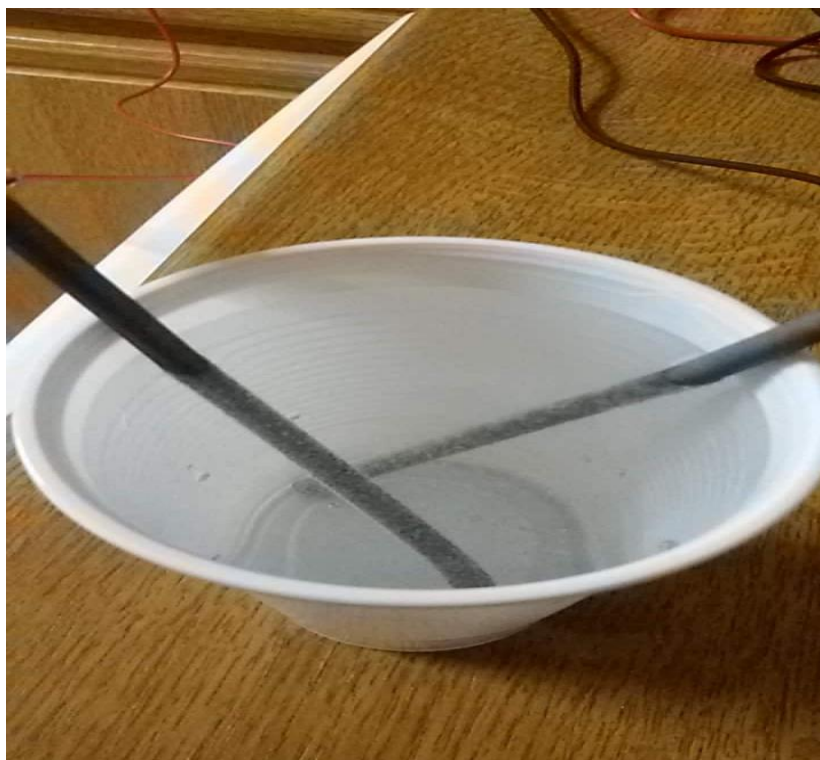
Εικόνα 17: Ηλεκτρόδια γραφίτη με παροχή τάσης
