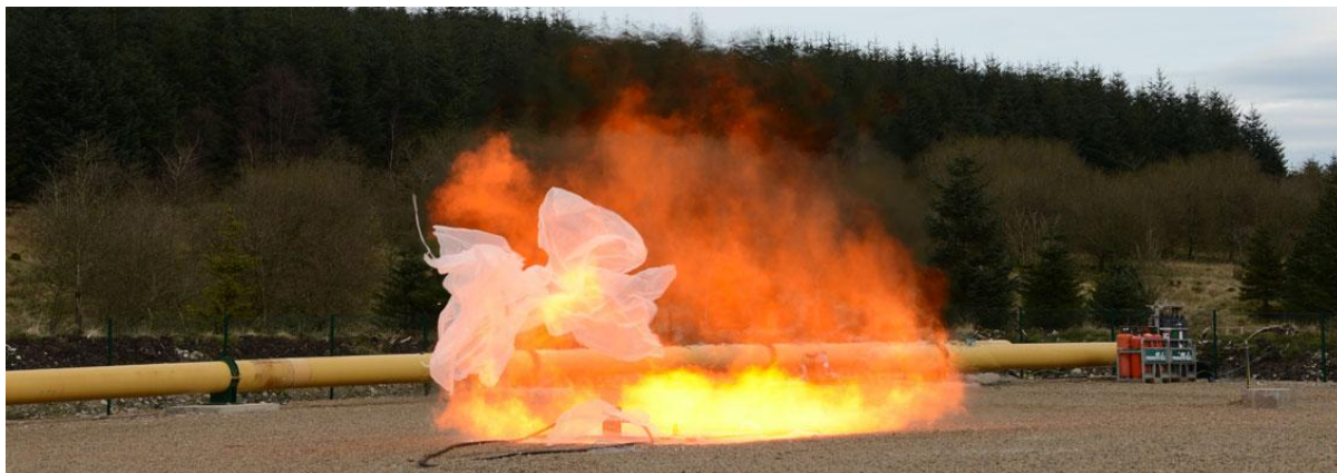
Εικόνα 10: Πείραμα για ανάφλεξη σε σωληνώσεις από ερευνητές του Ηνωμένου Βασιλείου
