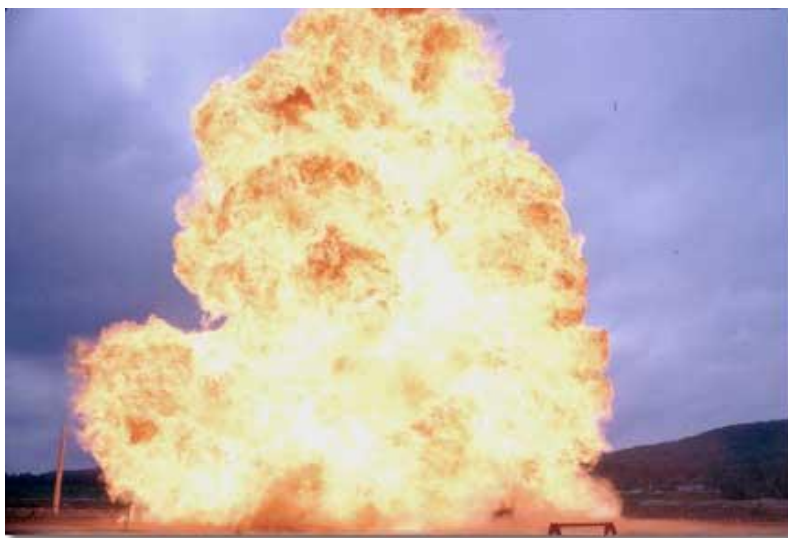
Εικόνα 12: Έκρηξη από ανάφλεξη αερίου υδρογόνου
