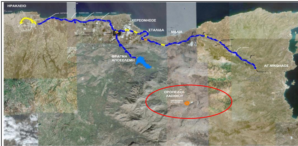
Εικόνα 2-7. Δίκτυα ύδρευσης Ανατολικής Κρήτης. Μέσα στο κόκκινο κύκλο, με πορτοκαλί χρώμα φαίνεται η λιμνοδεξαμενή του Αγ. Γεωργίου, ενώ η μπλε γραμμή παρουσιάζει το υδραγωγείο που τροφοδοτείται από το φράγμα Αποσελέμη.
