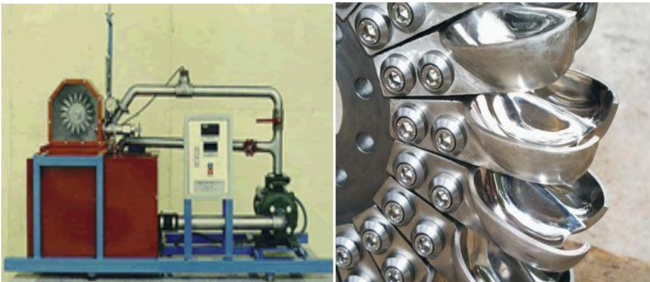
Εικόνα 3.3.2: Τρόπος εγκατάστασης και λειτουργίας Υδροστρόβιλου πρόπτωσης.
