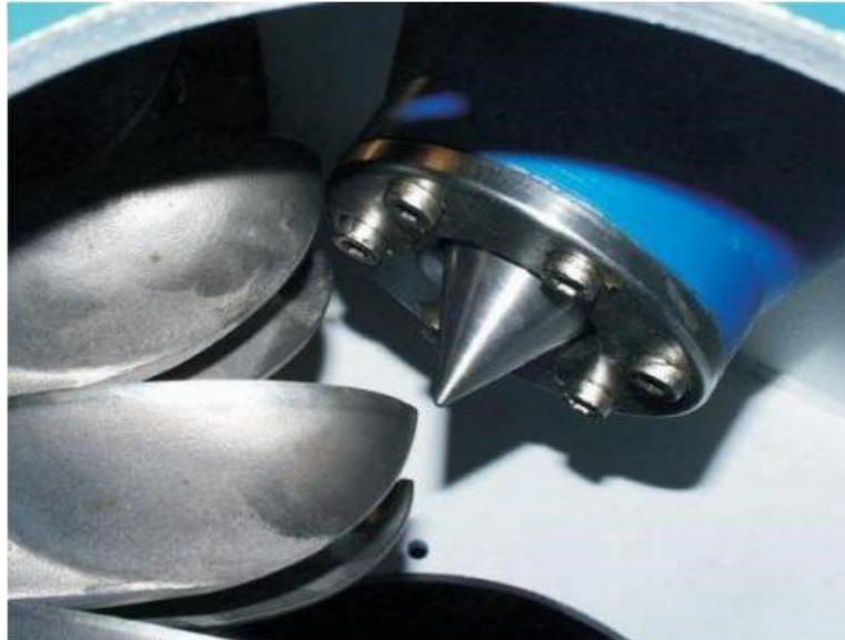
Εικόνα 3.3.3: Απεικόνιση δέσμης νερού (jet) να προσπίπτει στο δρομέα ώστε να παράξει περιστροφή.
