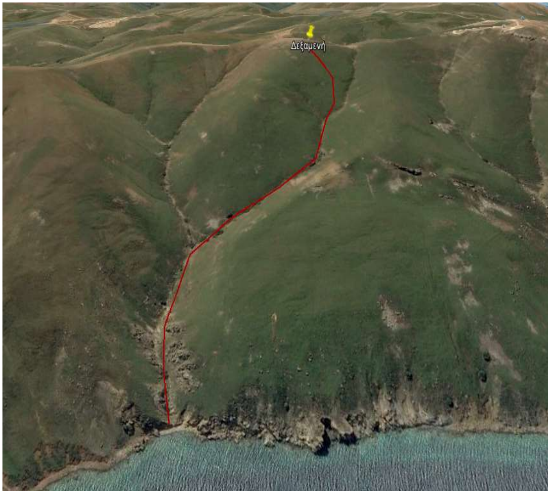
Εικόνα 5.7 Όδευση αγωγών υδροηλεκτρικού σταθμού
