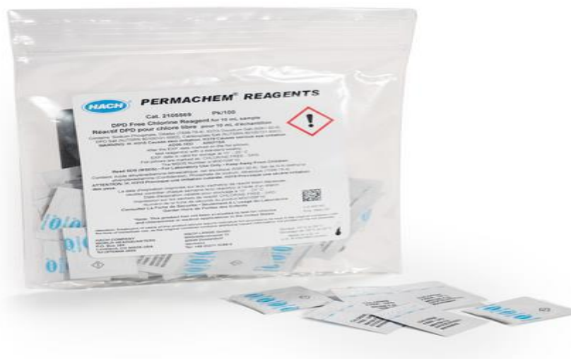
Εικόνα 5.2: Αντιδραστήρια για τον προσδιορισμό του υπολειμματικού ελεύθερου χλωρίου με την μέθοδο DPD (N,N-diethyl-p-phenylenediamine) FREE Chlorine. Εύρος μέτρησης: 0,02-2,00 mg/L Cl 2 . Μέγεθος δείγματος: 10 ml [4].
