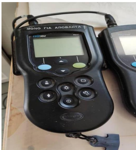
Εικόνα 5.8: Συσκευή Hach μέτρησης διαλυμένου οξυγόνου σε απόβλητα συνδεδεμένη με ηλεκτρόδιο Intellical LDO101 [4]
