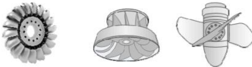
Εικόνα 7: Στρόβιλος Pelton, Francis, Kaplan (Guo B. et al, 2018)
