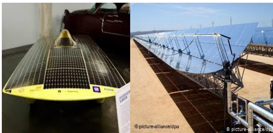
Εικόνα 11 : Το πρώτο ηλεκτρικό αυτοκίνητο που λειτουργεί μέσω φωτοβολταϊκών τύπου GaAs από φοιτητές του Πανεπιστημίου του Μίσιγκαν το 2005 (Αριστερά) και παραβολικό κάτοπτρο συγκέντρωσης ηλιακής ενέργειας με την χρήση φωτοβολταϊκού πλαισίου GaAs (δεξιά).
