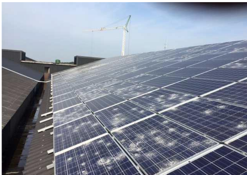
Εικόνα 28 : Απεικόνιση μικρό-ρωγμών σε φωτοβολταϊκή εγκατάσταση .
