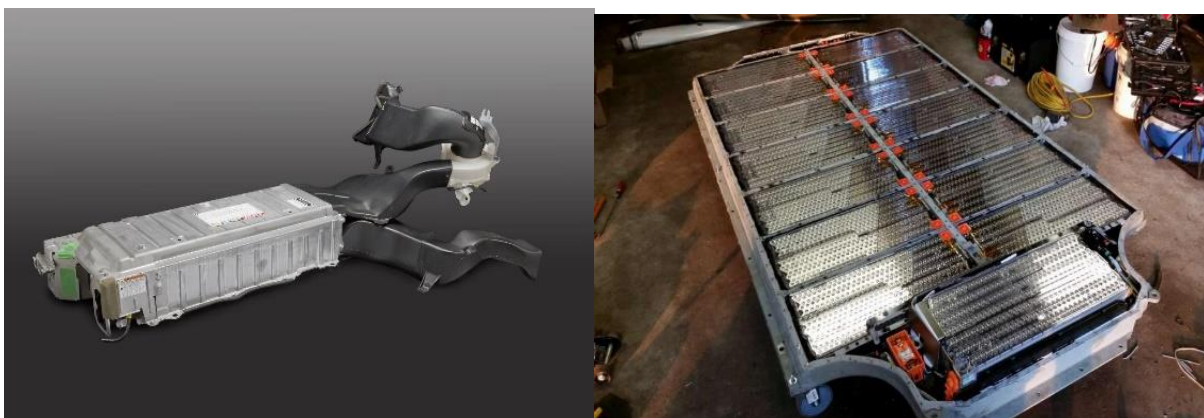
Εικόνα 20 : Μπαταρία Ni-MH ηλεκτρικού αυτοκινήτου (αριστερά) και μπαταρία Li-Io του Tesla Model S (δεξιά).
