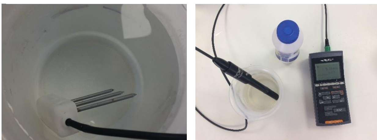
Εικόνα 2.11: Διαδικασία παρασκευής διαλυμάτων και προσδιορισμού τις αγωγιμότητες με του αισθητήρες GS3, 5TM, MEC 10.
