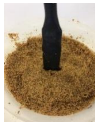
Εικόνα 2.13: Βαθμονόμηση και προσδιορισμό τις υγρασίας και τις αγωγιμότητας με τους αισθητήρες GS3, 5TM, MEC 10, Chirp!
