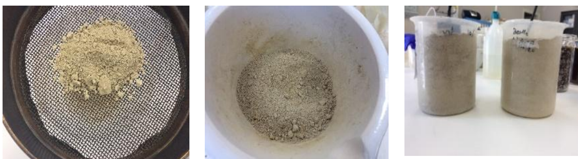
Εικόνα 2.15: Προετοιμασίας εδάφους και βαθμονόμηση για τον προσδιορισμό της υγρασίας και τις αγωγιμότητας
