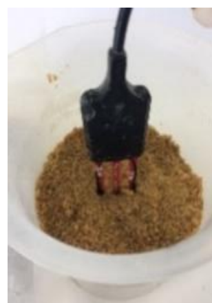
Εικόνα 2.12: Βαθμονόμηση και προσδιορισμός της εδαφικής υγρασίας σε διαφορετικές συγκεντρώσεις νερού με του αισθητήρες 5TM, GS3, MEC 10, Chirp!
