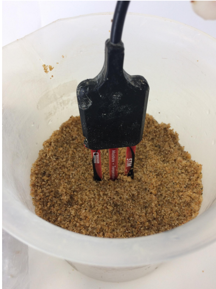
Εικόνα 2.7: Απεικονίζει τοποθέτηση του αισθητήρα 5TM στην άμμο
