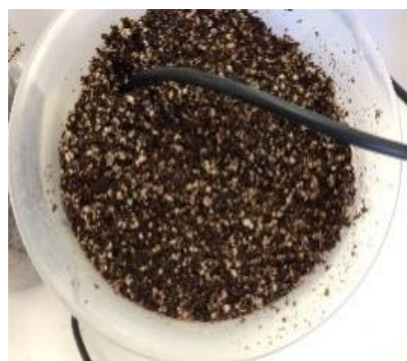
Εικόνα 2.14: Βαθμονόμηση και προσδιορισμό τις υγρασίας με τους αισθητήρες GS3, 5TM, MEC 10, Chirp!
