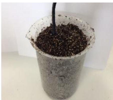
Εικόνα 2.14: Βαθμονόμηση και προσδιορισμό τις υγρασίας με τους αισθητήρες GS3, 5TM, MEC 10, Chirp!
