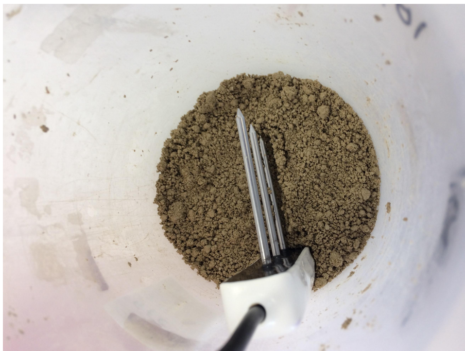
Εικόνα 2.5: Απεικόνιση τοποθέτησης του αισθητήρα GS3 στο έδαφος
