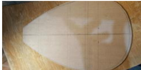
Εικόνα 3.4 - Σχεδίαση τοποθεσίας των καμαριών και της τρύπας
