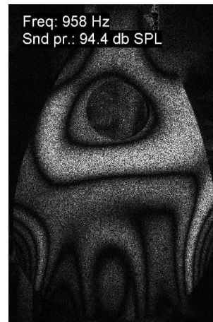
Εικόνα 9.12 – Μέγιστος συντονισμός 1040 Hz (πριν) και 958 Hz (μετά)
