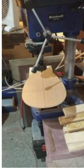
Εικόνα 3.6 - Ειδικό μηχάνημα για την κοπή της τρύπας.
