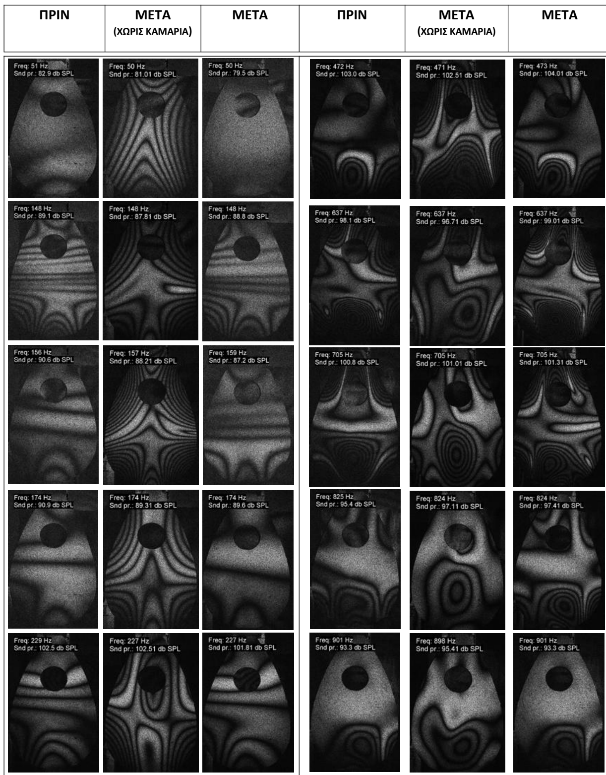
Εικόνα 8.1 - Απεικόνιση του ιδιορυθμίν του κατακλιού 1 πριν και μετά τη χημική επεξεργασία (50 – 900 Hz)
