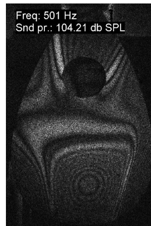
Εικόνα 9.8 – Μέγιστος συντονισμός 554 Hz (πριν) και 501 Hz (μετά)
