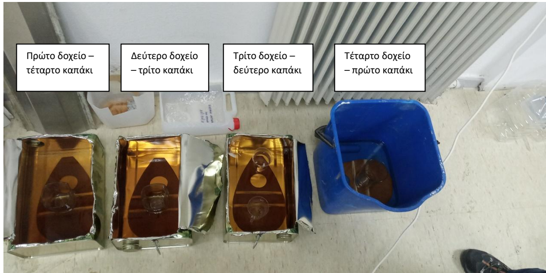
Εικόνα 6.4.1 – Τα καπάκια κατά τη διάρκεια του εμποτισμού
