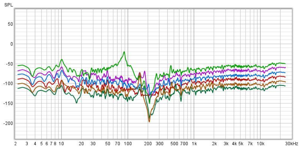
Εικόνα 8.2.4 – Συχνотική απόκριση για καπάκι 1 πριν και μετά (χωρίς καμάρια), για όλες τις θέσεις Λιλά χρώμα πριν (αριστερά), κόκκινο χρώμα πριν (μέση), πράσινο σκούρο χρώμα (δεξιά) πριν , πράσινο ανοικτό χρώμα (αριστερά) μετά, μπλε χρώμα (μέση) μετά και πορτοκαλί χρώμα (δεξιά) μετά .
