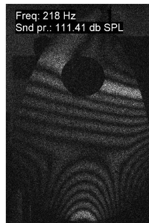
Εικόνα 9.9 – Μέγιστος συντονισμός στα 258 Hz (πριν) και 218 Hz (μετά)
