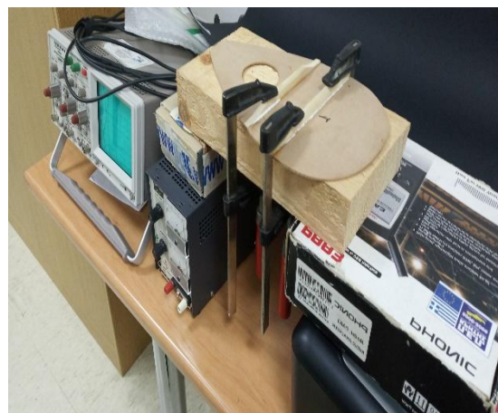
Εικόνα 6.4.3 – Καπάκι 1 κατά τη διαδικασία επανακόλλησης των καμαριών
