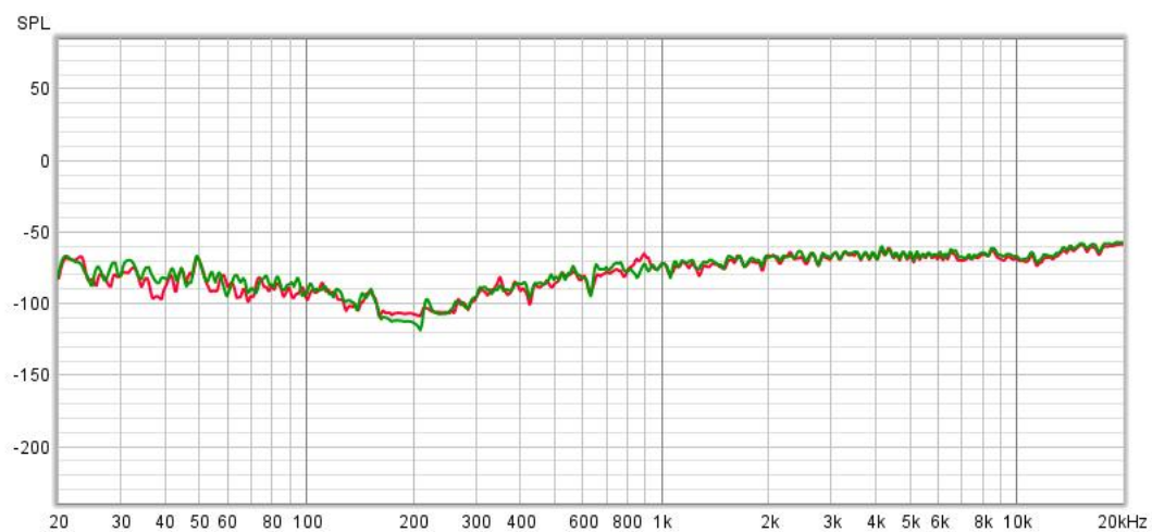
Εικόνα 8.2.5 – Συχνотική απόκριση για καπάκι 1 πριν και μετά (με καμάρια), θέση αριστερά στο καπάκι. Λιλά χρώμα πριν και πορτοκαλί χρώμα μετά.
