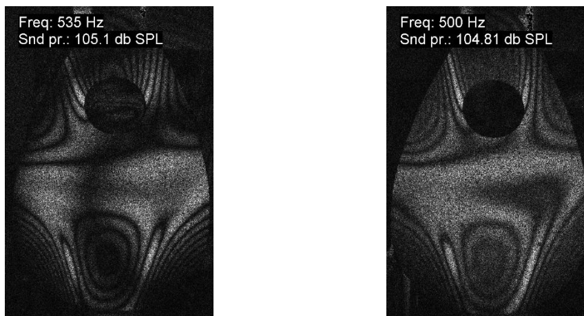
Εικόνα 9.10 – Μέγιστος συντονισμός στα 535 Hz (πριν) και 500 Hz (μετά)
