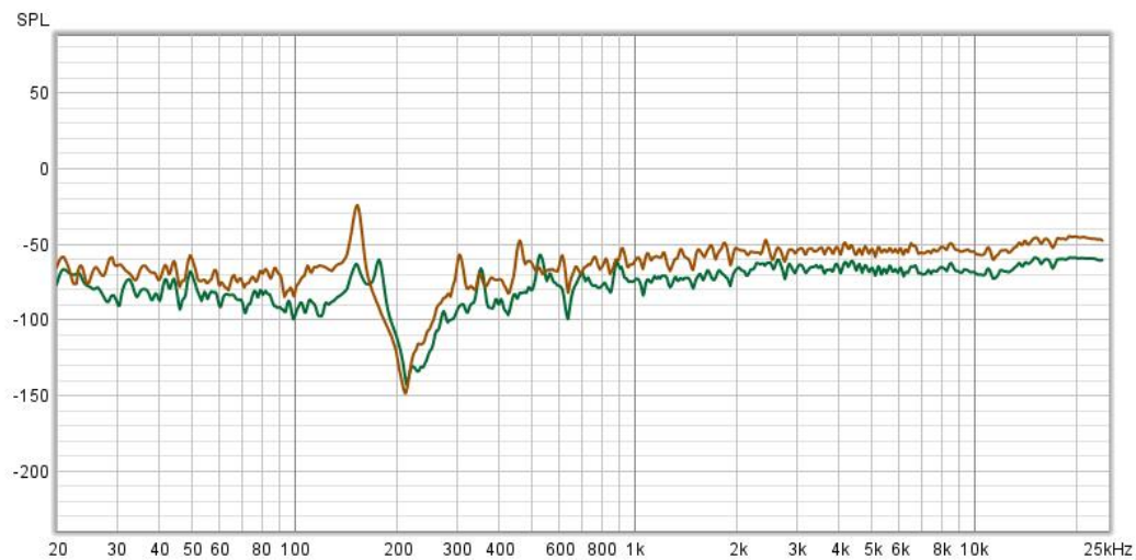
Εικόνα 8.2.3 – Συχνοτική απόκριση για καπάκι 1 πριν και μετά (χωρίς καμάρια), θέση δεξιά στο καπάκι. Πράσινο χρώμα πριν και πορτοκαλί χρώμα μετά.
