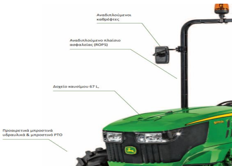
Εικόνα 2.8 : Παρουσίαση μπροστινού μέρους τρακτέρ της εταιρείας John Deere με ύπαρξη αναδιπλούμενο πλαισίου ασφαλείας.
