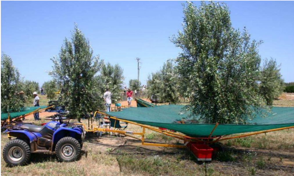
Εικόνα 2.15: α) Παρουσίαση καινοτόμου μηχανικής διάταξης ισπανικού τύπου δονητή με ανάποδη ομπρέλα.
