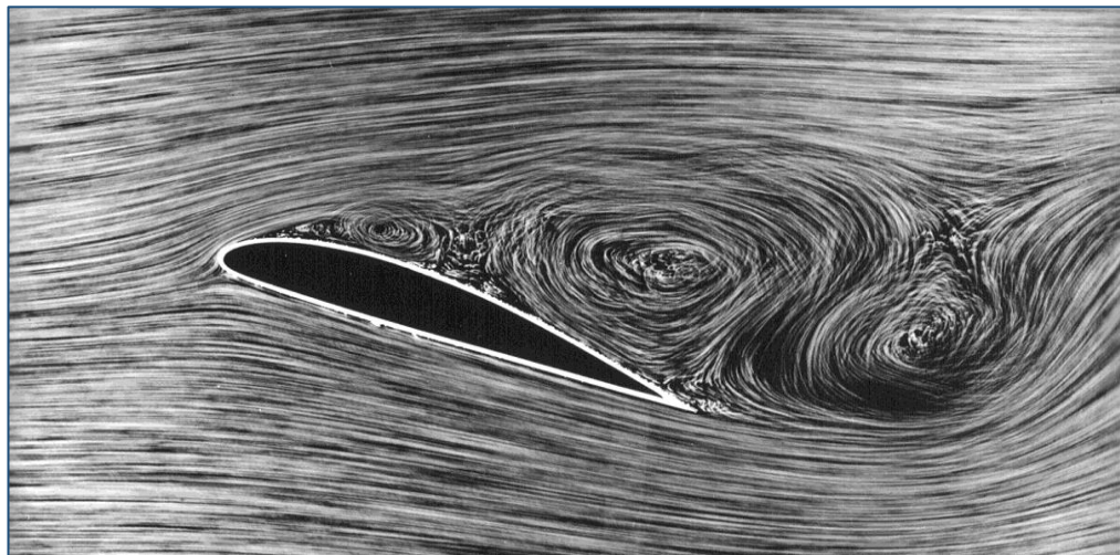
Σχήμα 4.3.1.2: Αναπαράσταση του φαινομένου αποκόλληση ροής (stall) εξαιτίας μεγάλης γωνίας προσβολής ( https://en.wikipedia.org/wiki/Stall_(fluid_dynamics) )
