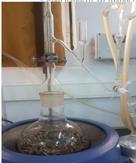
Εικόνα 22: Αποστακτική συσκευή τύπου Clevenger στην οποία υπάρχει υλικό προς απόσταξη
