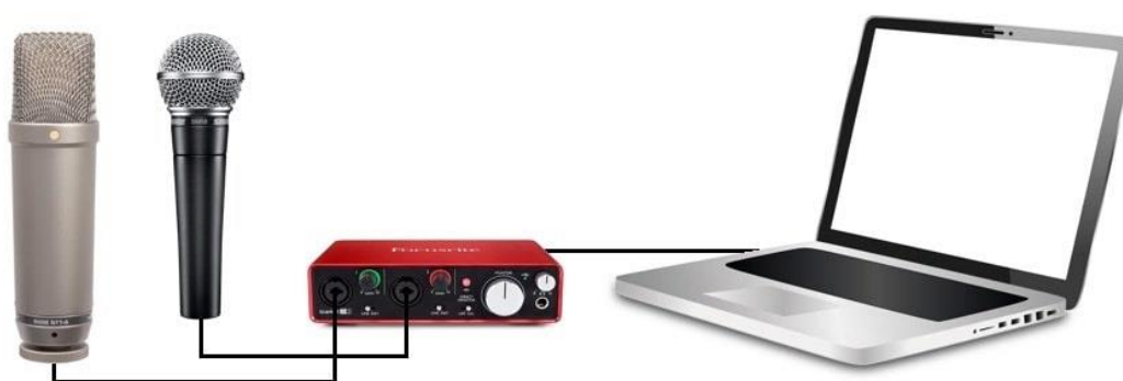
Εικόνα 66: Σχεδιάγραμμα σύνδεσης μικροφώνου - κάρτας ήχου - Η/Υ 384
