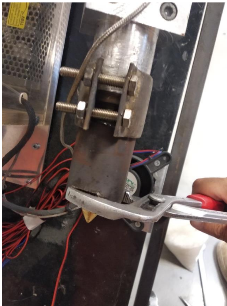
Εικόνα 5.12 : Μπροστινό κομμάτι του εξωθητήρα που βγαίνει κατά τη λειτουργία.
