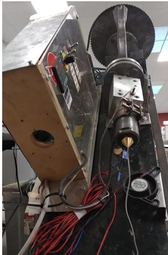
Εικόνα 5.10 : Νήμα μετά την αντικατάσταση του ακροφυσίου.
