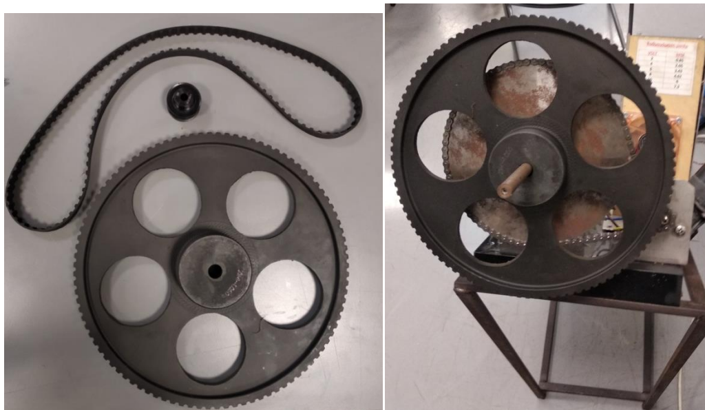
Εικόνα 5.4 : Η τροχαλία του άξονα του extruder.
