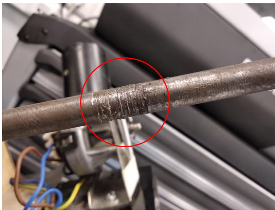
Εικόνα 5.3 : Φθαρμένος άξονας του εξωθητή.
