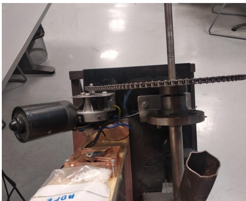
Εικόνα 5.6. :β. Τελική θέση της τροχαλίας του άξονα του extruder.
