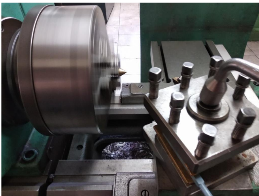
Εικόνα 5.9 : Κατασκευή ακροφυσίου στον τόννο.
