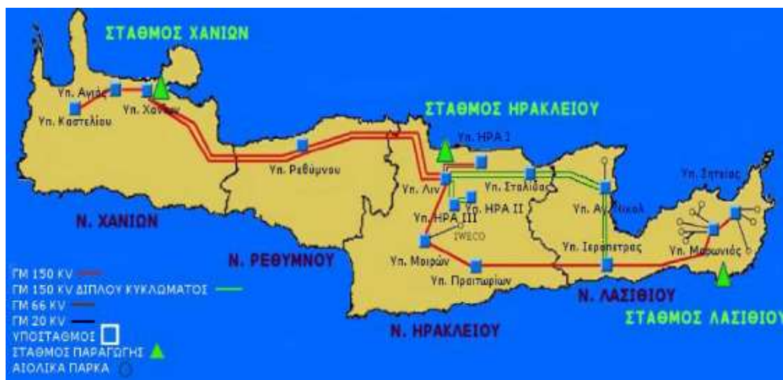
Εικόνα 2.1. Το σύστημα ηλεκτρικής ενέργειας Κρήτης
