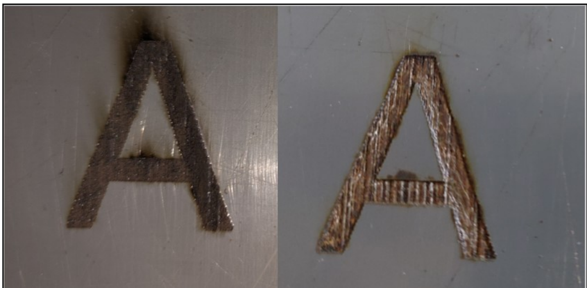
Εικόνα 6.11: Χάραξη με τη μέθοδο Raster Engrave σε πλαστικό PVC (5 περάσματα/mm). Αριστερά: Αποτέλεσμα χάραξης. Δεξιά: Αποτέλεσμα χάραξης μετά την απομάκρυνση του υποδομημένου υλικού
