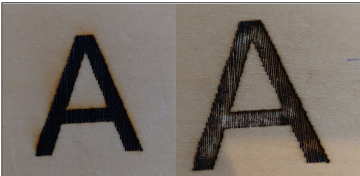
Εικόνα 6.10: Χάραξη με τη μέθοδο Raster Engrave σε ξύλο (3 περάσματα/mm). Αριστερά: Αποτέλεσμα χάραξης. Δεξιά: Αποτέλεσμα χάραξης μετά την απομάκρυνση του υποδομημένου υλικού
