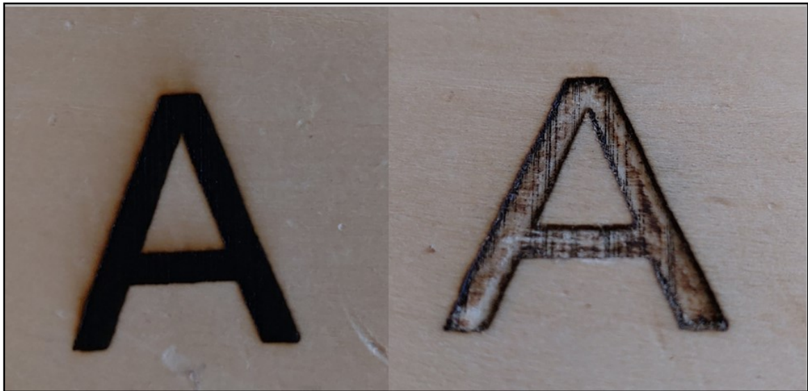
Εικόνα 6.10: Χάραξη με τη μέθοδο Raster Engrave σε ξύλο (5 περάσματα/mm). Αριστερά: Αποτέλεσμα χάραξης. Δεξιά: Αποτέλεσμα χάραξης μετά την απομάκρυνση του υποδομημένου υλικού
