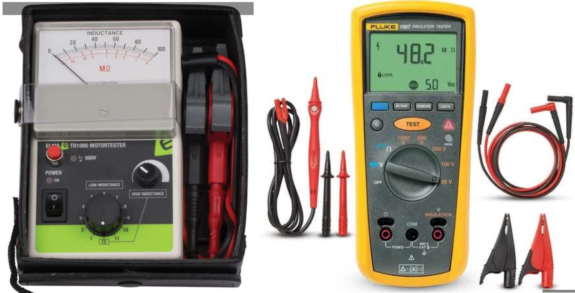
Εικόνα 31. Motor tester (αριστερά) και Megger insulation tester (δεξιά)
