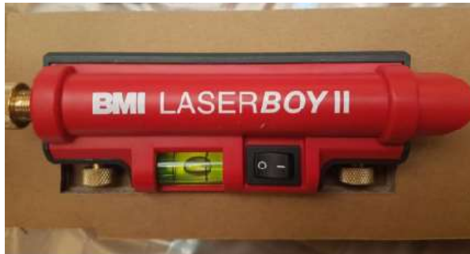
Εικόνα 35. Όργανο ευθυγράμμισης ανεμομέτρου με τον άξονα της νασέλας
