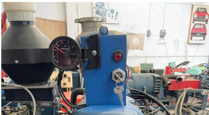
Εικόνα 41 Στην φωτογραφία διακρίνονται η λυχνία φωτός, ο διακόπτης εκκίνησης και το όργανο μέτρησης των στροφών του κινητήρα.
