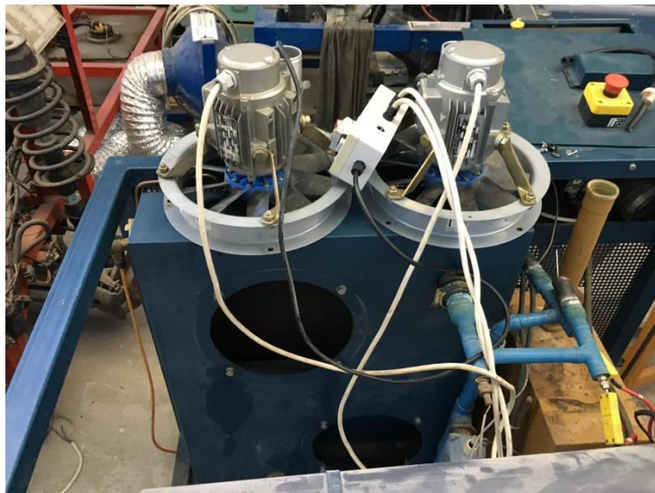
Εικόνα 45 Τα δύο βεντιλατέρ-ανεμιστήρες του συστήματος ψύξης μαζί με το κουτί ασφαλειών εκκίνησης τους.
