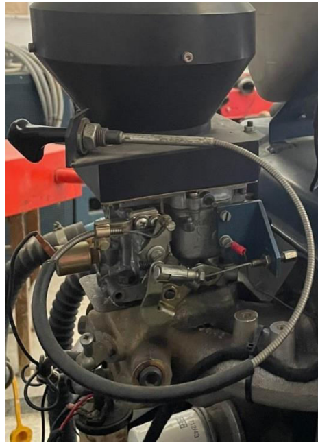
Εικόνα 48 Το καρμπυρατέρ τοποθετημένο και συναρμολογημένο έπειτα από τη διαδικασία καθαρισμού του.
