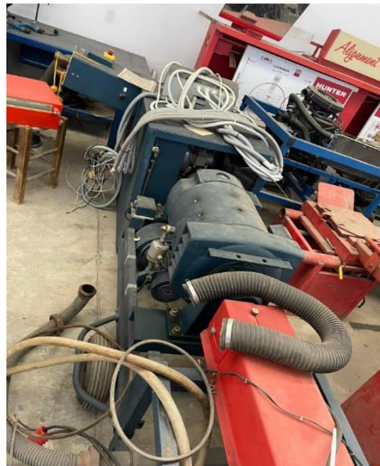
Εικόνα 38 Το εργαστηριακό δυναμόμετρο νερού στο οποίο ήταν συνδεδεμένος ο εργαστηριακός κινητήρας.
