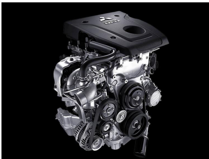
Εικόνα 10 Τετρακύλινδρος πετρελαιοκινητήρας αυτοκινήτου με μέγιστη δυνατότητα απόδοσης 2500 κυβικών εκατοστών (πηγή : MITSUBISHI).
