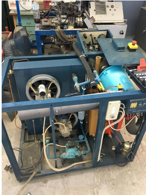
Εικόνα 43 : Η αρχική μονάδα ψήξης και παροχής νερού του συστήματος Μηχανής Εσωτερικής Καύσης-δυναμόμετρου.
