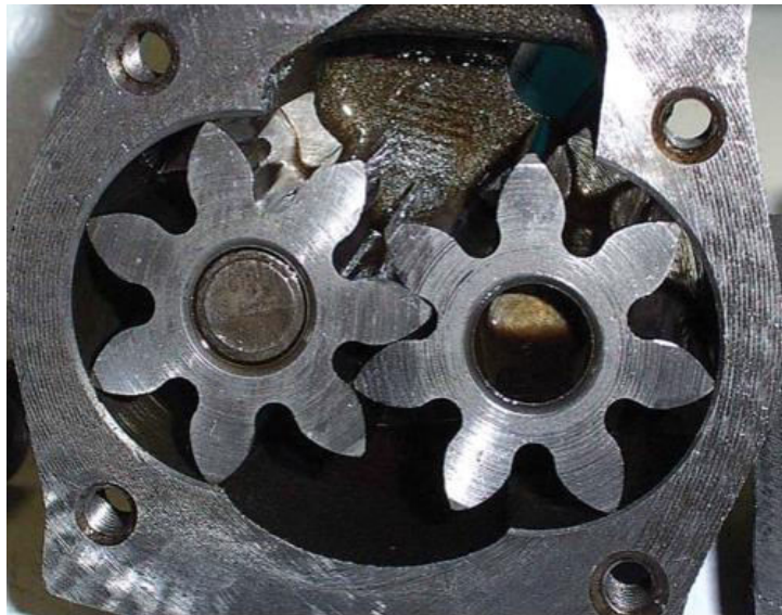
Εικόνα 29 Αντλία οδόντωσης εμπλεκόμενων γραναζιών. (πηγή: διαδικτυακή ιστοσελίδα βελτίωσης και ενημέρωσης αυτοκινήτου «POWER AUTOMOTIVE MAGAZINE»).
