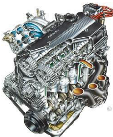
Εικόνα 6 Τετρακύλινδρος βενζινοκινητήρας αυτοκινήτου (πηγή : HONDA).
