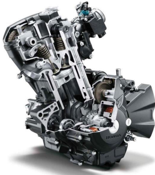
Εικόνα 7 Μονοκύλινδρος κινητήρας μοτοσυκλέτας (πηγή : HONDA).
