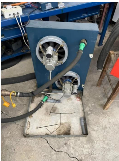
Εικόνα 46 Το ολοκληρωμένο πλέον σύστημα του ψυγείου ψύξης του κινητήρα με τοποθετημένα τα δύο βεντιλατέρ και τις καινούριες σωληνώσεις ένωσης με τον κινητήρα (τα πράσινα μέρη αποτελούν τα δύο κομμάτια σωληνώσεων –
