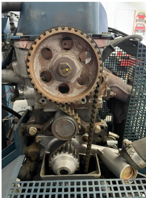
Εικόνα 49 Στη φωτογραφία απεικονίζεται ο καινούργιος ιμάντας χρονισμού τοποθετημένος στα σημεία του.
