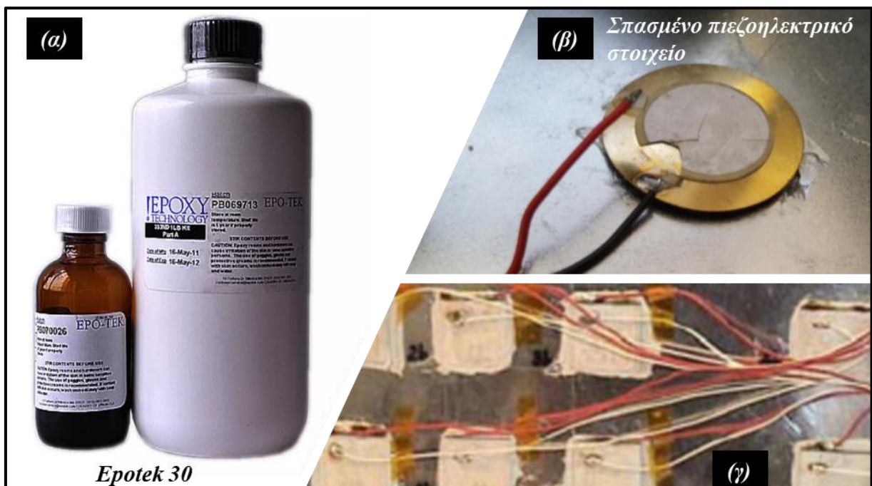
Εικόνα 2.12: Κολημένα πιεζοηλεκτρικά στοιχεία, (α) ειδική εποξική κόλλα για την κόλληση των πιεζοηλεκτρικών στοιχείων πάνω στις κατασκευές, (β) κακή τοποθέτηση πιεζοηλεκτρικού στοιχείου με αποτέλεσμα την καταστροφή του, (γ) σωστά τοποθετημένα πιεζοηλεκτρικά στοιχεία σε λεπτό πτερύγιο.
