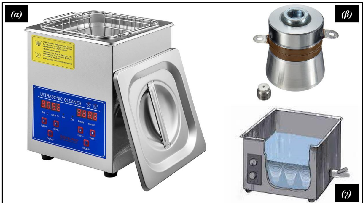
Εικόνα 3.16: Καθαριστής υπερήχων με την χρήση πιεζοηλεκτρικού ηχοβολέα (β).
