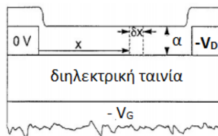
Σχήμα: 4-8 Διαστάσεις κατά μήκος του αγωγίμου διαύλου του OFET [23] .
