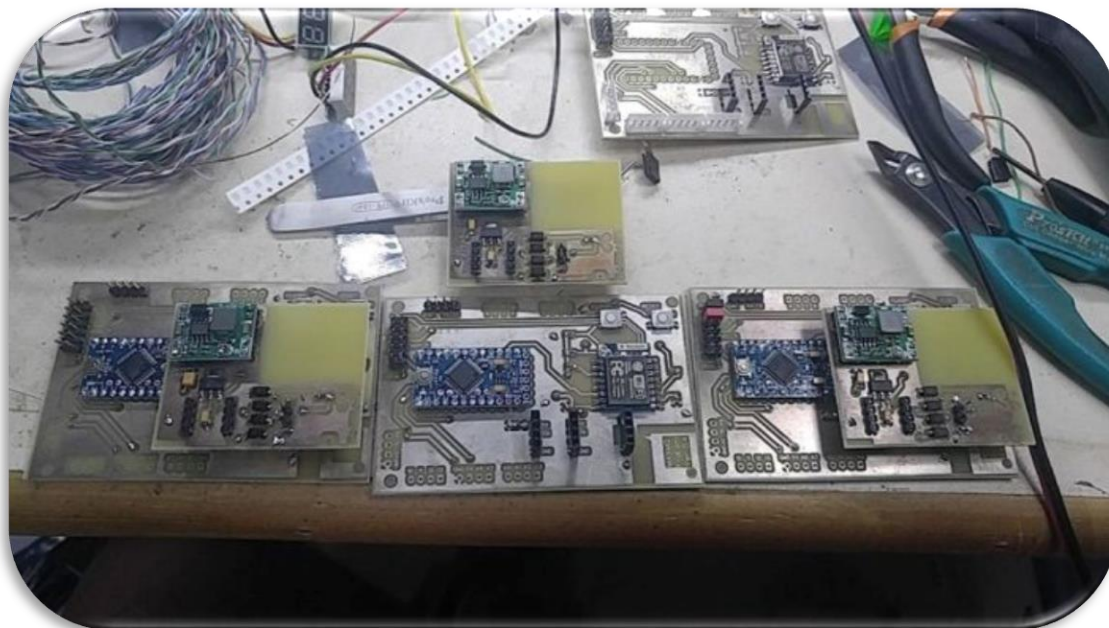
Εικόνα 14 Συναρμολόγηση πλακετών μετά την εκτύπωση για δόκιμες.
