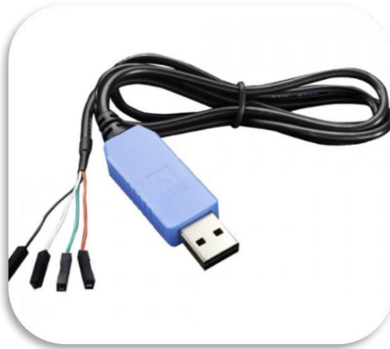
Εικόνα 18 Καλώδιο για τον πρώτο προγραμματισμό της πλατφόρμας μετά τον προγραμματισμό μπορούμε να αλλάζουμε το firmware του μικροελεγκτή ασύρματα
