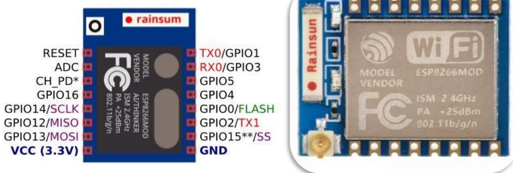
Εικόνα 7 Το module esp8266 έκδοση 07 μαζί με τις εξόδους του
