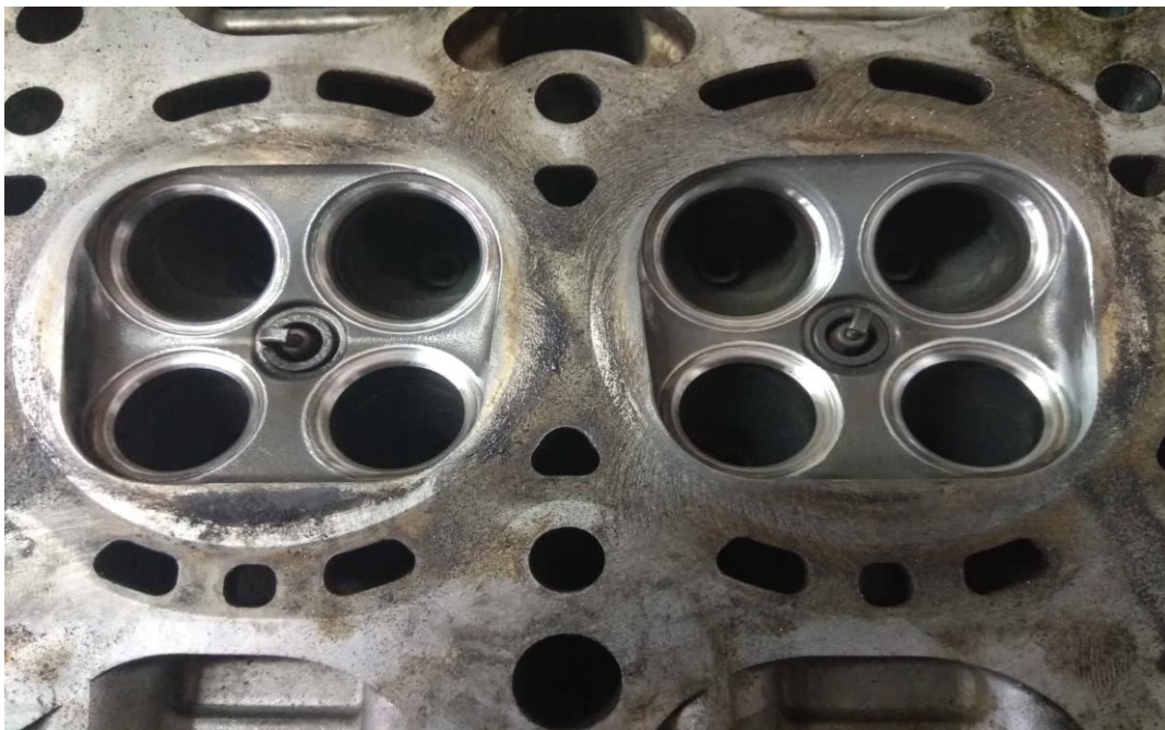
σχήμα 6.6.2 έδρες βαλβίδας κυλινδροκεφαλής μετά το ρεκτιφιέ
