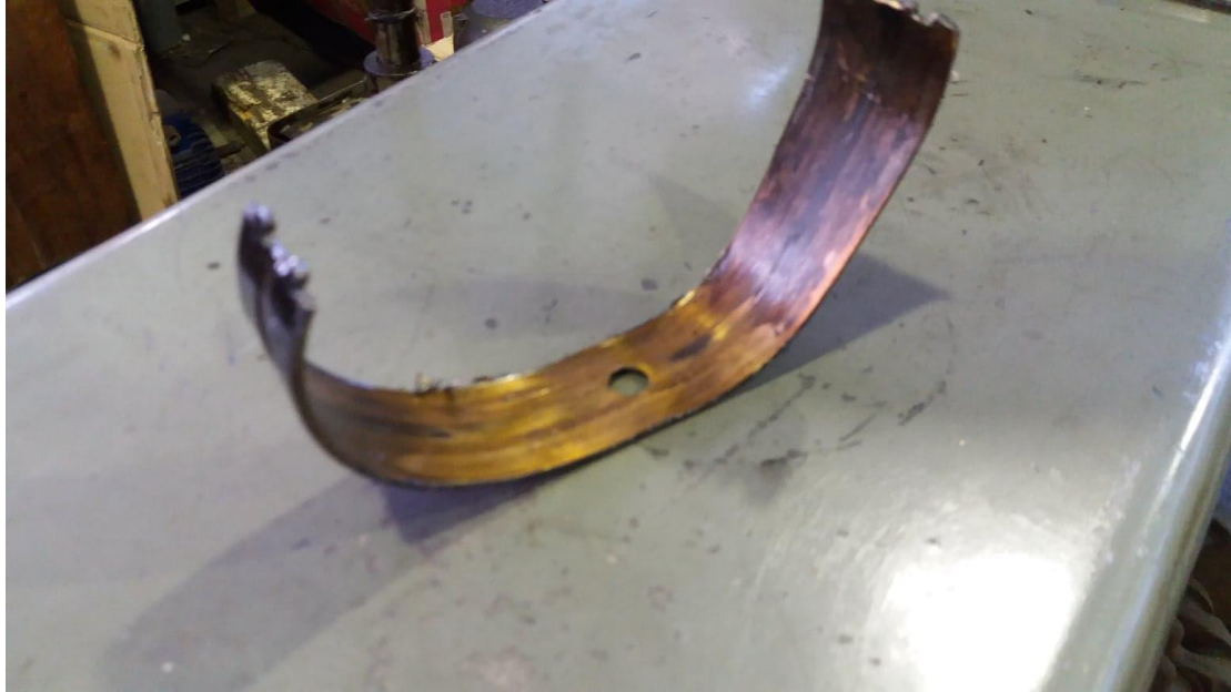
σχήμα 7.6.2. χτυπημένο μέταλλο κομβίου στροφαλοφόρου άξονα
