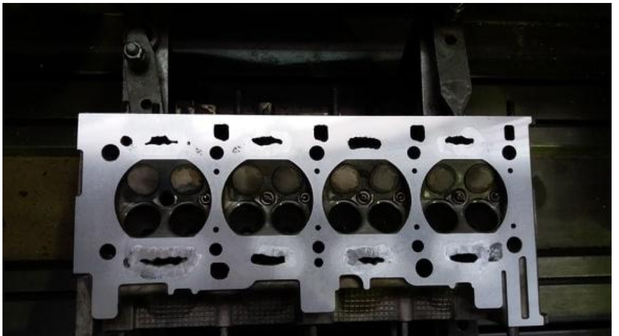
σχήμα 6.3.3 επαναφορά ομοιομορφίας κυλινδροκεφαλής
