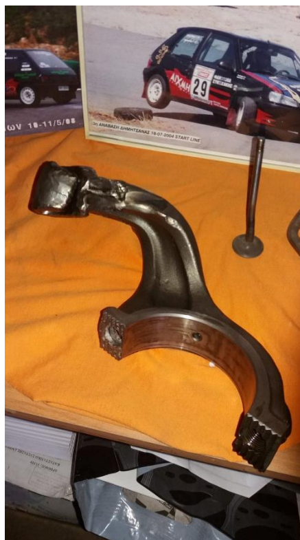
σχήμα 7.6.4 ακραίο στράβωμα διωστήρα
