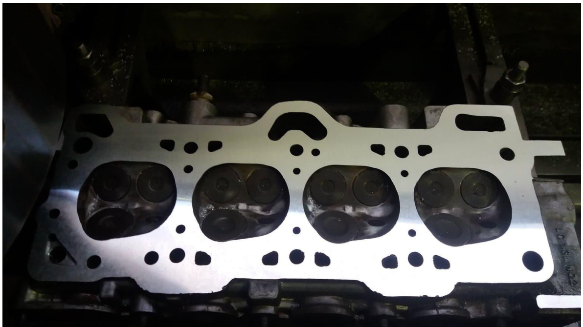
σχήμα 5.2.4. επαναφορά ομοιομορφίας κυλινδροκεφαλής
