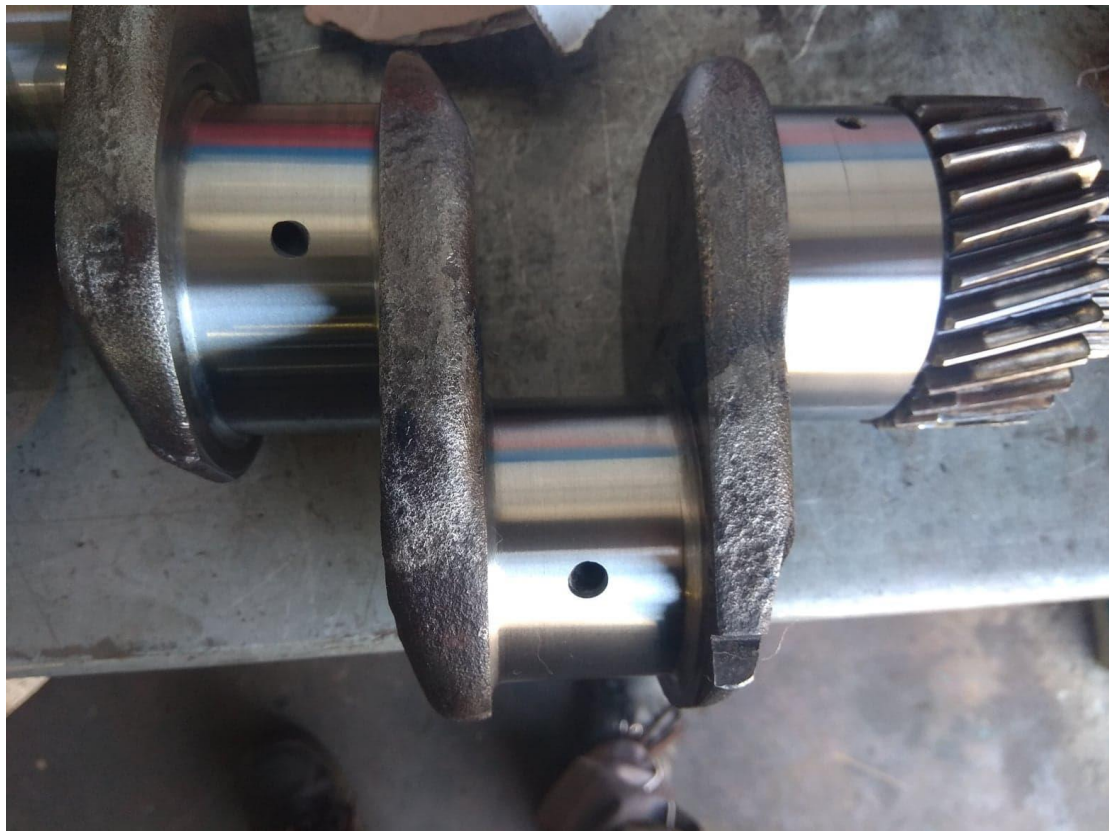
σχήμα 7.8.3 επαναφορά ομοιομορφίας σε κομβίο διωστήρα στροφαλοφόρου άξονα
