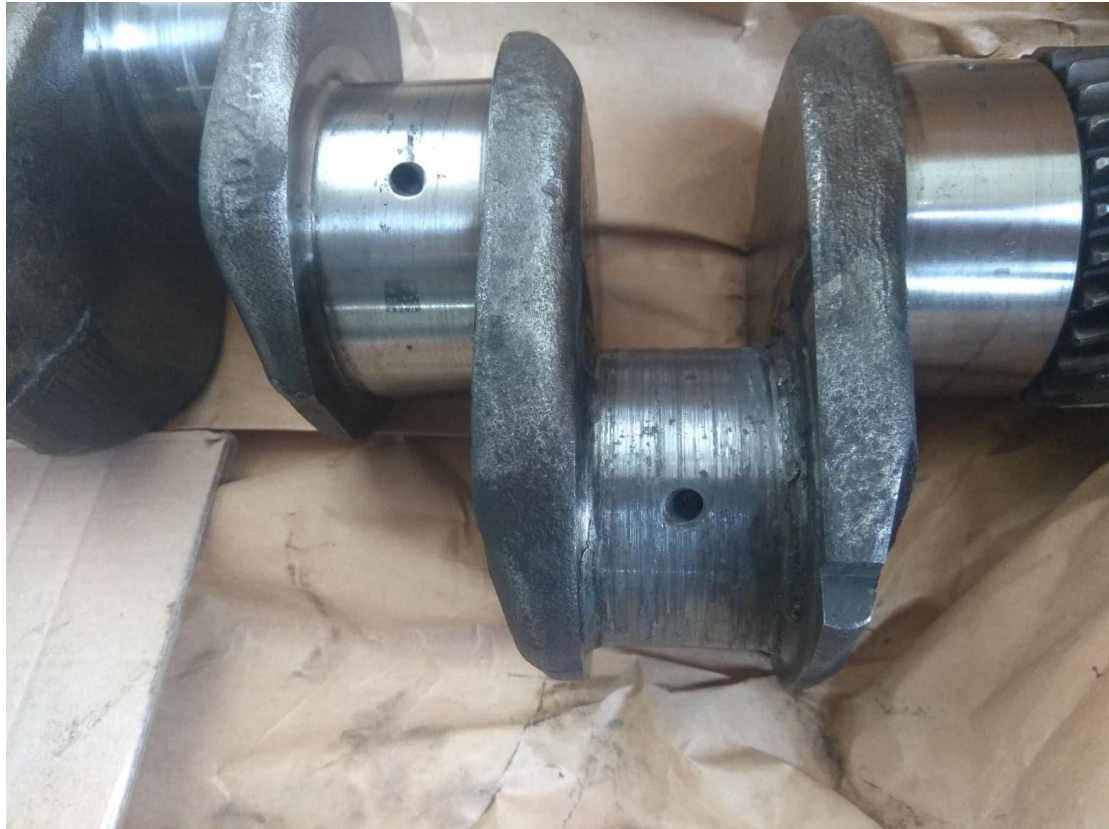
σχήμα 7.8.2 χτύπημα κομβίου διωστήρα σε στροφαλοφόρο άξονα
