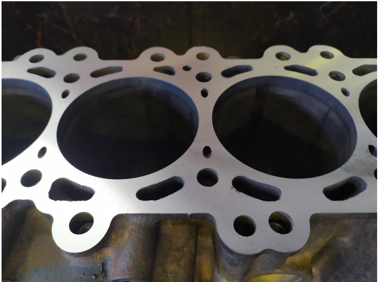
σχήμα 7.5.1 στρώση κάπνας στο εσωτερικό του κυλίνδρου
