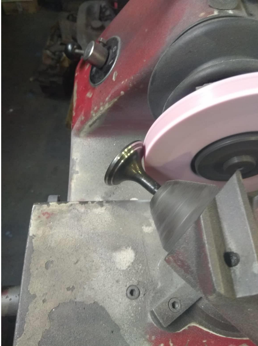
σχήμα 6.5.2 ρεκτιφιέ βαλβίδας – κάψιμο στο σημείο επαφής με έδρα κυλινδροκεφαλής
