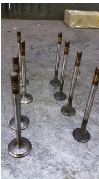
σχήμα 6.5.1 Βαλβίδες εισαγωγής (αριστερά) και βαλβίδες εξαγωγής (δεξιά)
