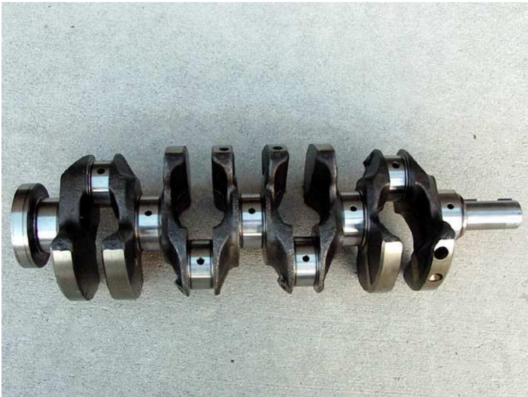
σχήμα 7.8.1 οπές λίπανσης στα κομβία στροφαλοφόρου άξονα
