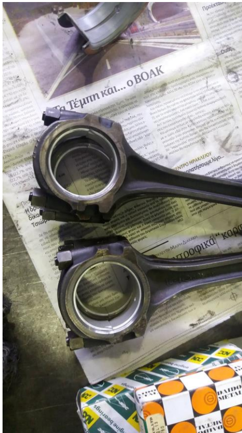
σχήμα 7.6.3. διωστήρας με εφαρμοσμένα τα μέταλλα
