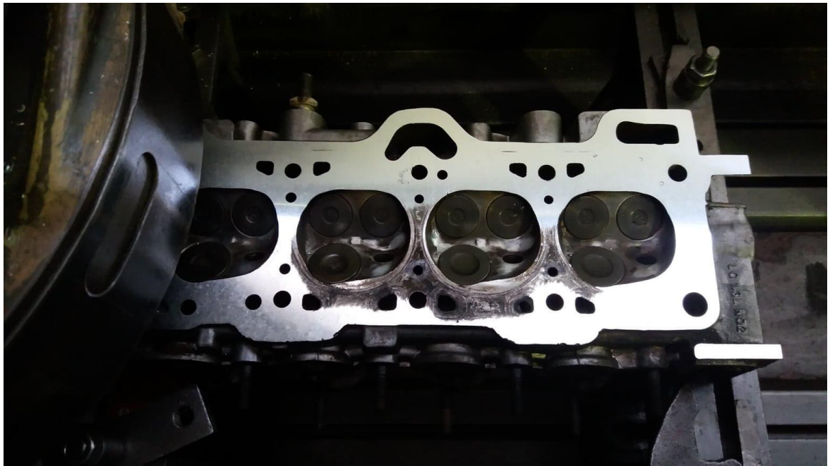
σχήμα 5.2.3 ρεκτιφιέ κυλινδροκεφαλής – εμφάνιση σημείου υπερθέρμανσης φλάντζας κυλινδροκεφαλής
