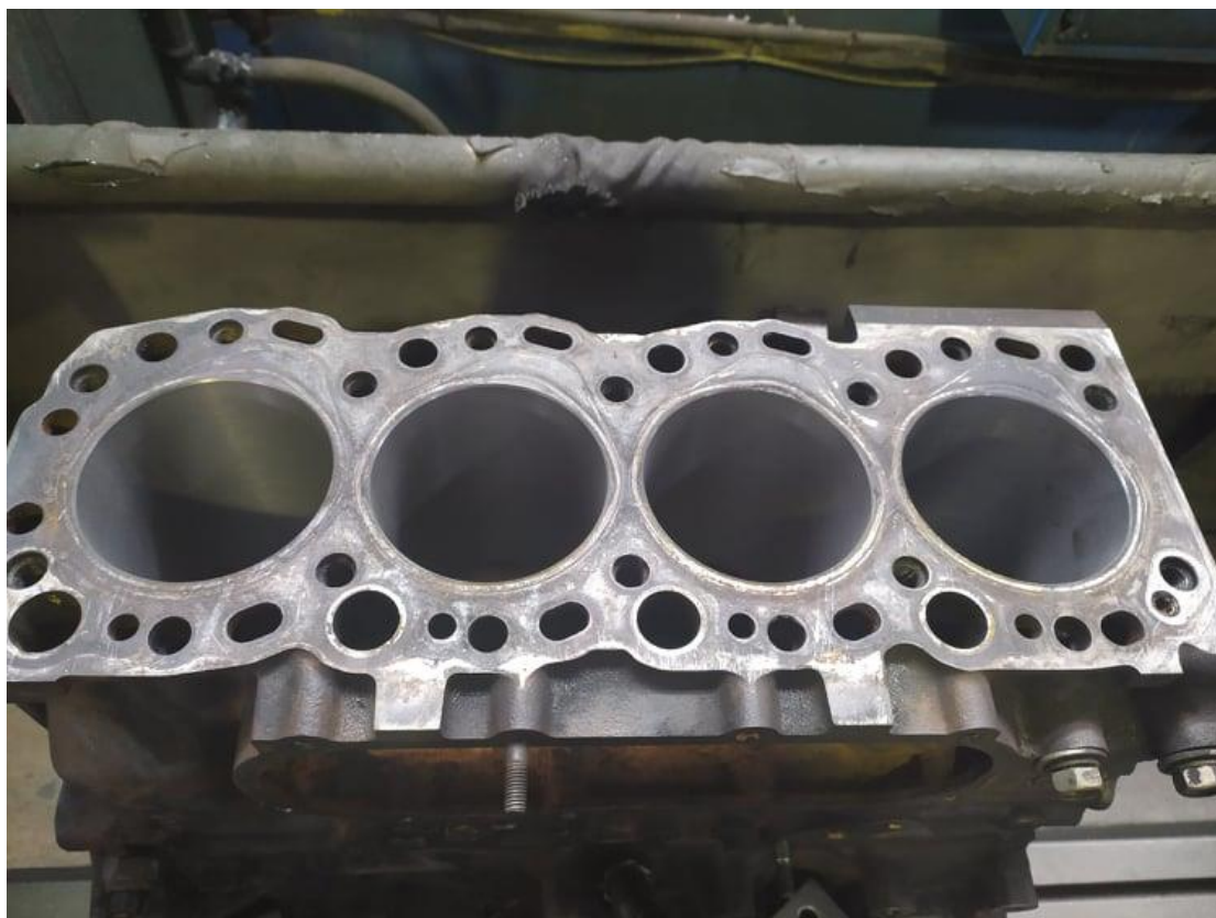
σχήμα 7.2.1 κάψιμο φλάντζας κεφαλής στον κορμό
