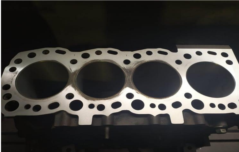
σχήμα 7.2.2. ρεκτιφιε επιφάνειας κορμού – εμφάνιση σημείου υπερθέρμανσης στην επιφάνεια κορμού
