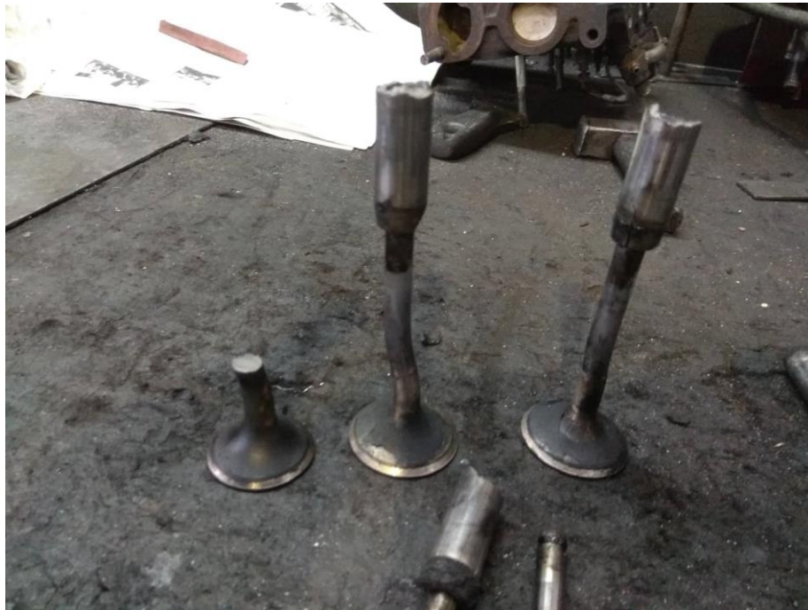
σχήμα 6.5.5 κομμένες βαλβίδες – σπασμένοι οδηγοί βαλβίδων κυλινδροκεφαλής
