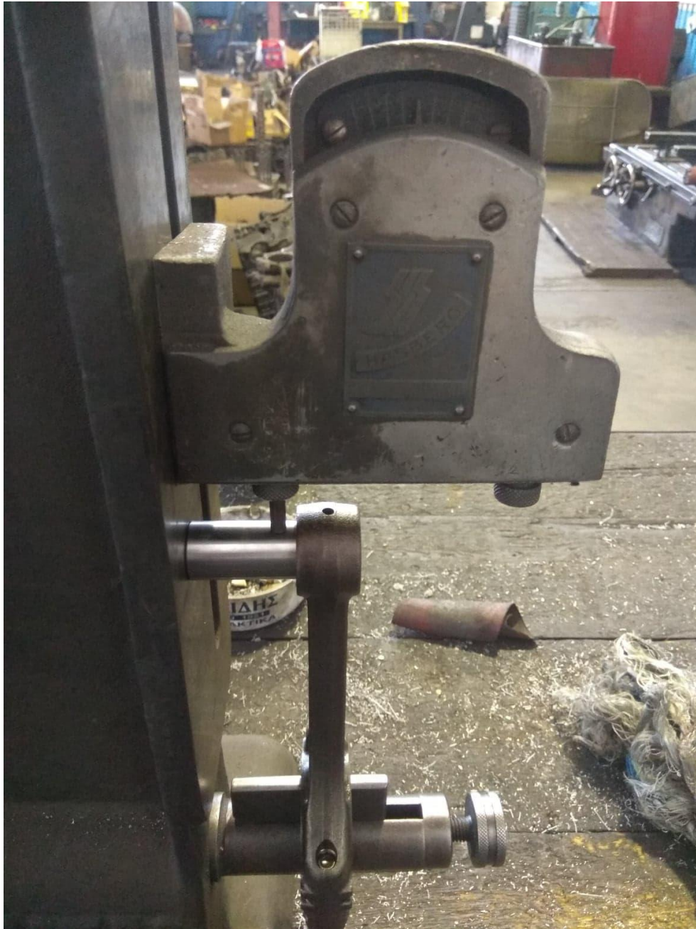
σχήμα 7.6.5. έλεγχος στραβώματος διωστήρα
