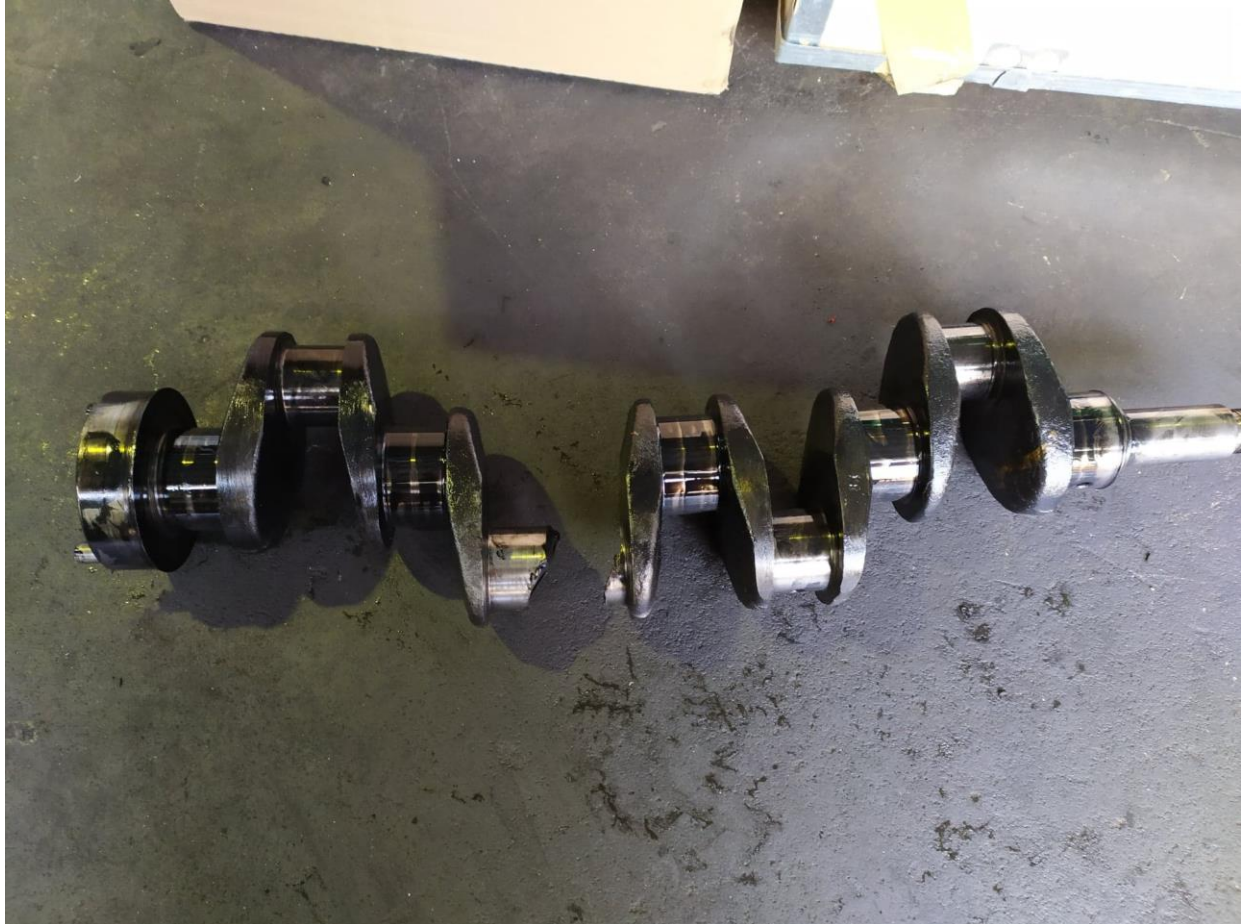
σχήμα 7.8.4 κόψιμο στροφαλοφόρου άξονα σε κομβίο διωστήρα
