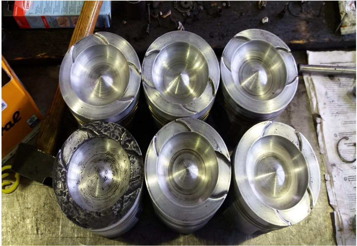
σχήμα 7.7.1 χτύπημα εμβόλου από θραύσμα στο χώρο καύσης
