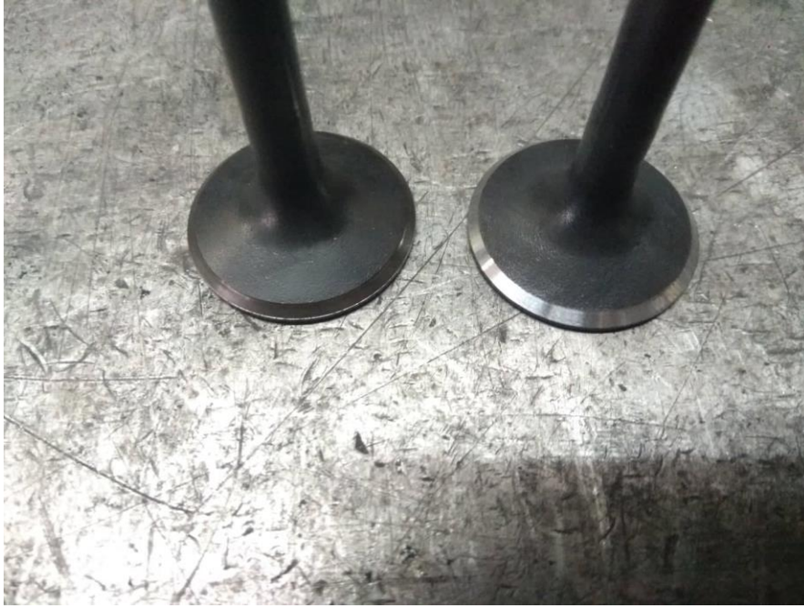
σχήμα 6.5.3 βαλβίδα με κάψιμο (αριστερά) – βαλβίδα μετά το ρεκτιφιέ (δεξιά)
