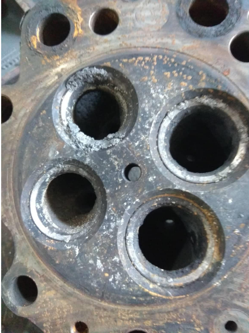
σχήμα 6.6.4. βλάβη έδρας βαλβίδας από θραύσματα
