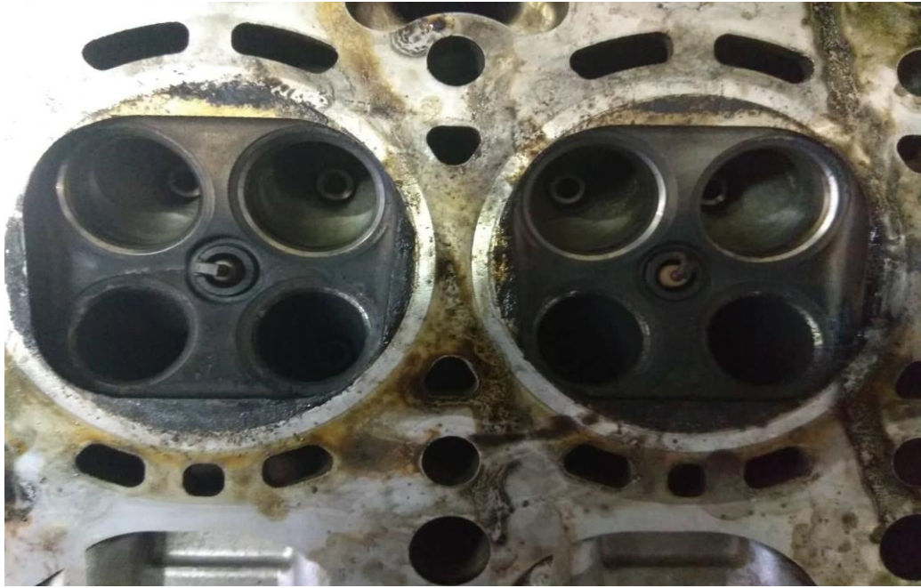
σχήμα 6.6.1 κάψιμο στις έδρες βαλβίδας κυλινδροκεφαλής
