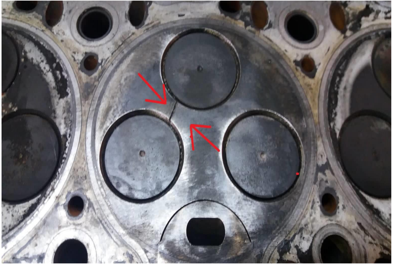
σχήμα 6.4.1 Ρήγμα κυλινδροκεφαλής ανάμεσα σε βαλβίδες εισαγωγής και εξαγωγής
