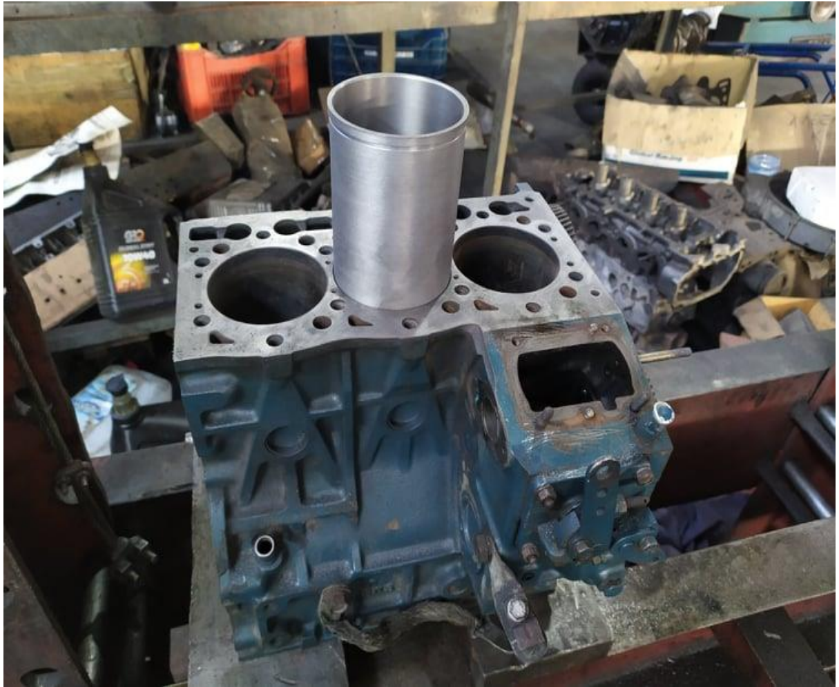
σχήμα 7.4.3. εισαγωγή χιτωνίων κυλίνδρου με πρεσάρισμα
