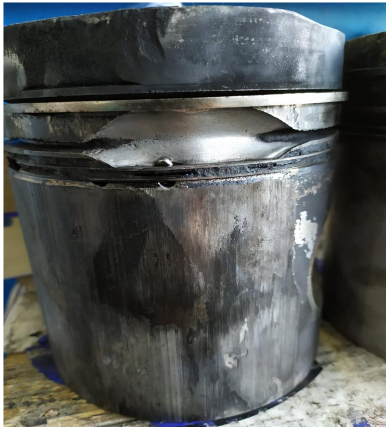
σχήμα 7.7.2 σπάσιμο καναλιών ελατηρίων εμβόλου
