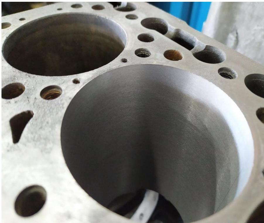
σχήμα 7.3.4. Επαναφορά ομοιομορφίας μετά το 2 ο ρεκτιφιέ
