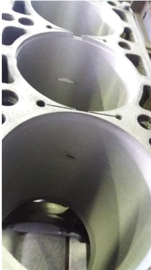
σχήμα 7.3.1. Χτύπημα κυλίνδρου από σπασμένο ελατήριο
