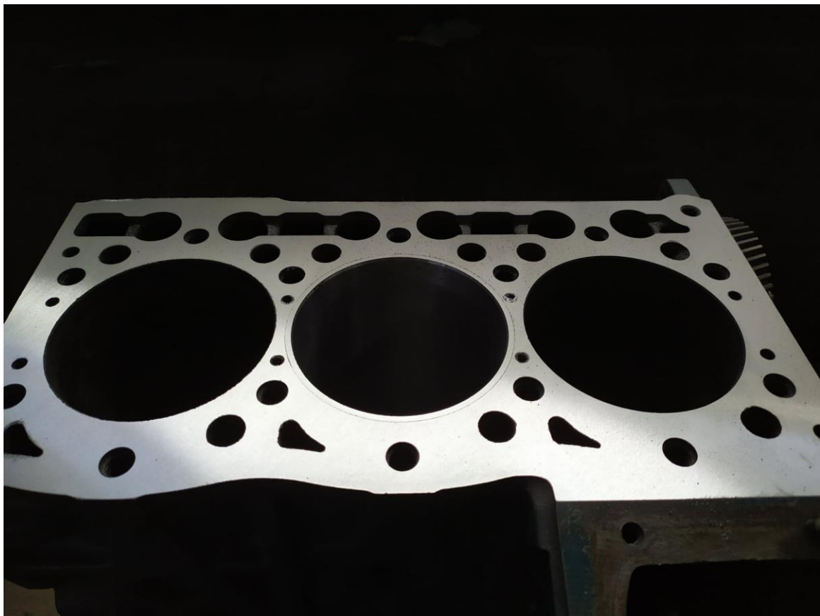
σχήμα 7.4.5 κατεργασία προσώπου κορμού μετά την εισαγωγή χιτωνίων
