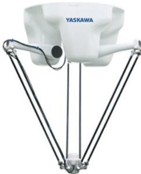
Εικόνα 3-2 Το Yaskawa MPP3H έχει οριζόντια εμβέλεια 1300mm.
