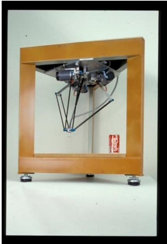
Εικόνα 2-2 Το πρώτο πρωτότυπο του δέλτα ρομπότ(Ιανουάριος 1986)
