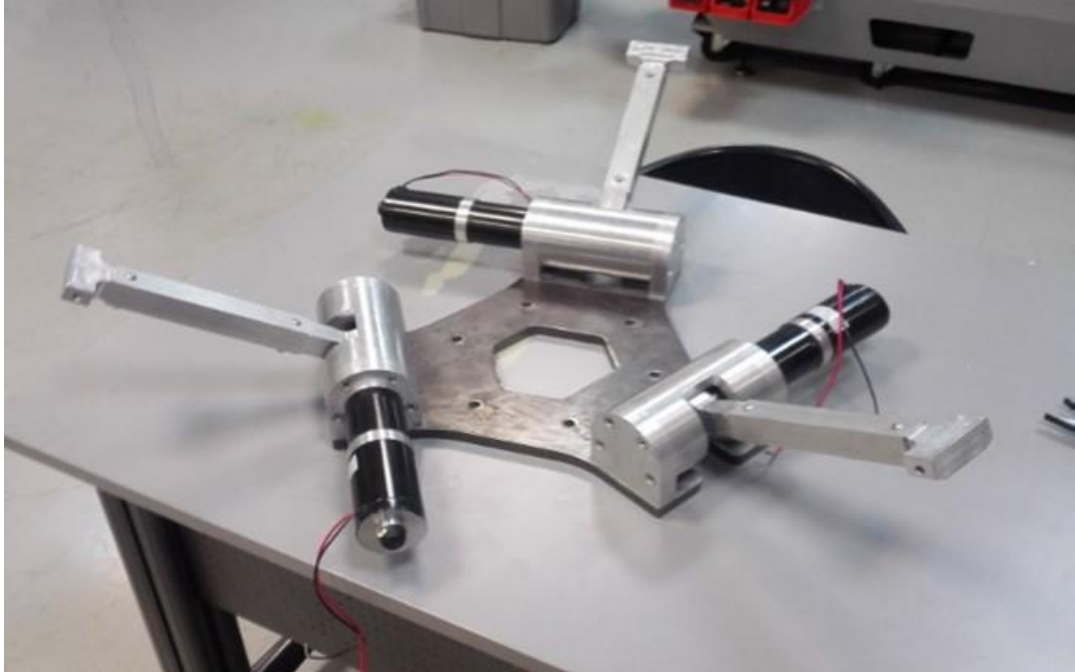
Εικόνα 6-5 Η πάνω βάση μαζί με το σύνολο βραχίονας-κουζινέτο-μοτέρ
