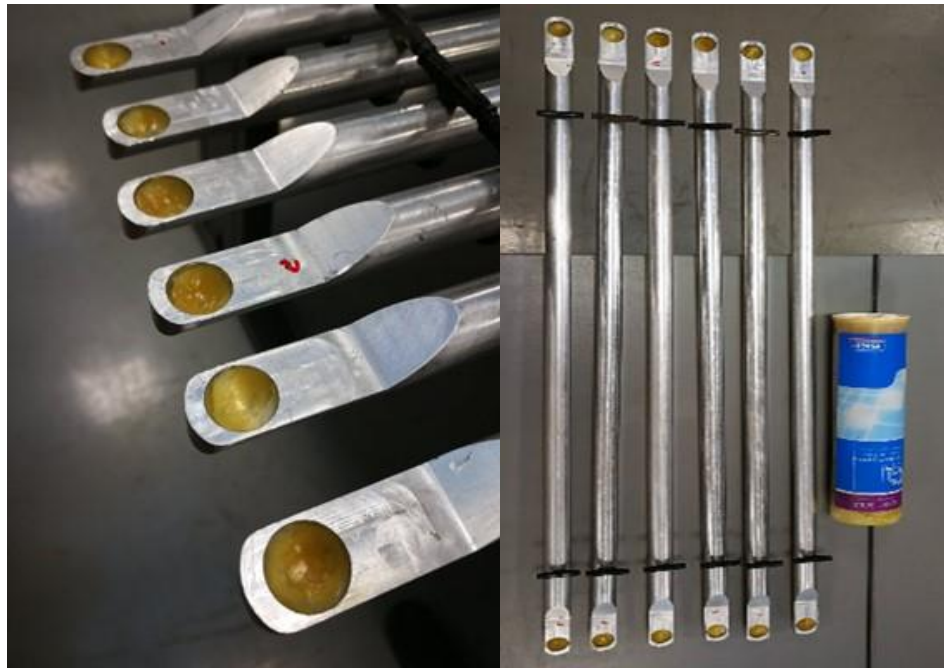
Εικόνα 6-7 Εφαρμογή γράσσου στις σπές των σφαιρικών αρθρώσεων
