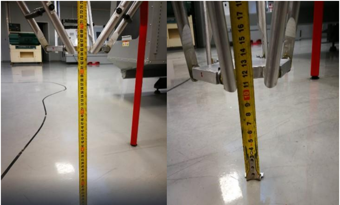
Εικόνα 6-12 Μέγιστη και ελάχιστη απόσταση της κινούμενης βάσης από την πάνω σταθερή βάση.
