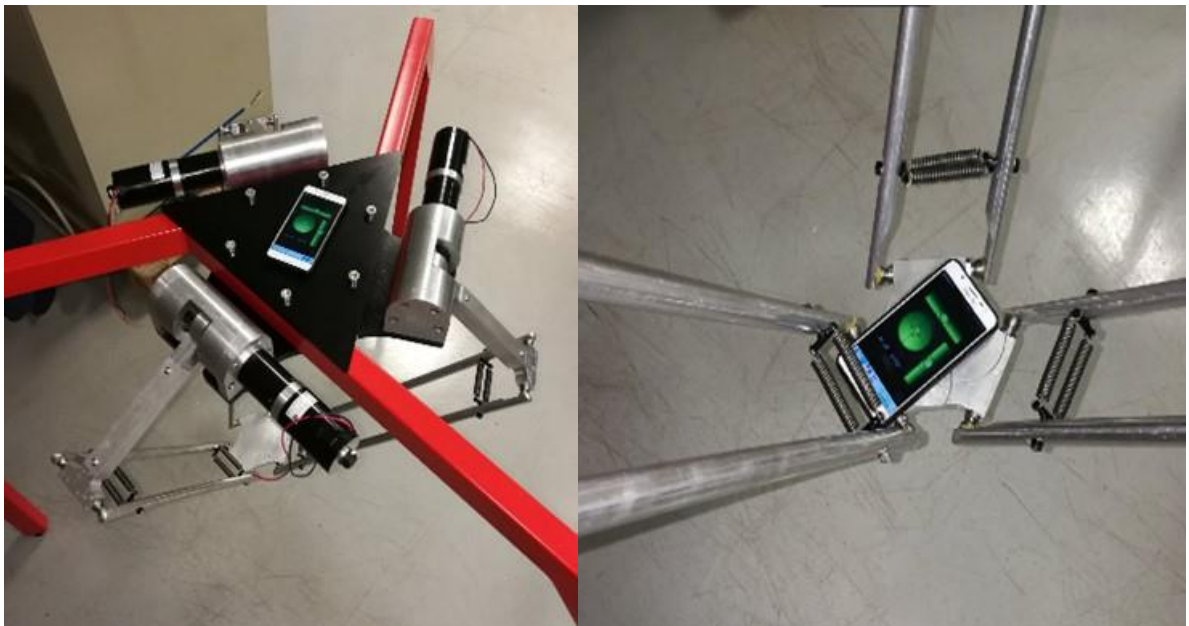
Εικόνα 6-11 Επαλήθευση παραλληλότητας της πάνω σταθερής βάσης με την κάτω κινούμενη βάση
