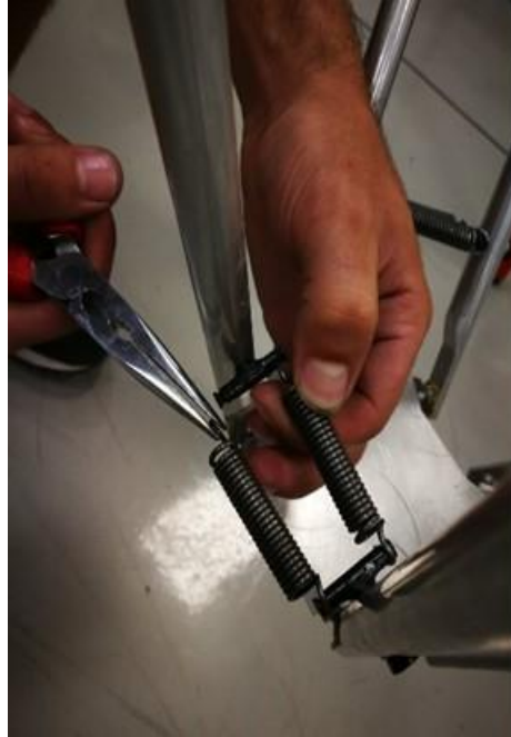
Εικόνα 6-9 Τοποθέτηση των ελατηρίων
