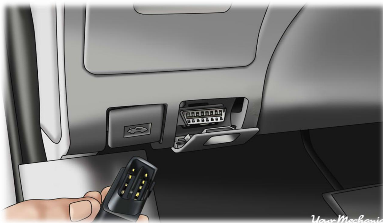
Εικόνα 4.1 Θύρα OBD II κάτω από το ταμπλό των οργάνων του αυτοκίνητου
