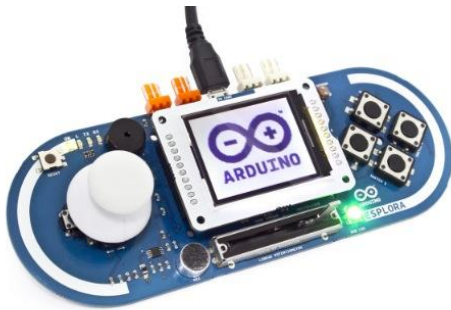
Εικόνα 3.10.8 Arduino Esplora με οθόνη TFT LCD
