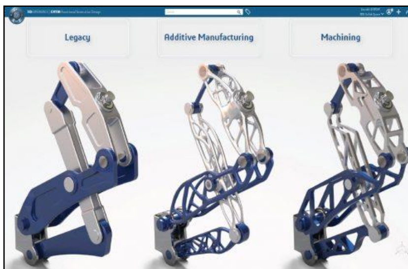
Εικόνα 3. 1: Βελτιστοποίηση μηχανισμών με generative design και με δυνατότητα τρισδιάστατης εκτύπωσης.
