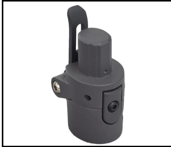
Εικόνα 6.1.4.2: Απομονωμένος μηχανισμός αναδίπλωσης. Μοντέλο Xiaomi Mi M365.
