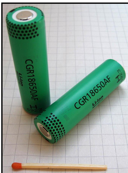
Εικόνα 4.6.1: Κυψέλες ιόντων λιθίου 18650, φωτογραφία από Wikimedia Commons.
