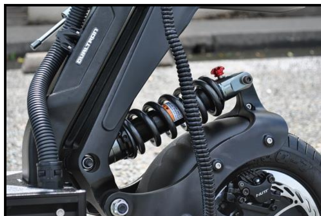
Εικόνα 4.8.5.2: Ανάρτηση τύπου ελατηρίου, μπροστά τροχού, μοντέλο Dualtron X.
