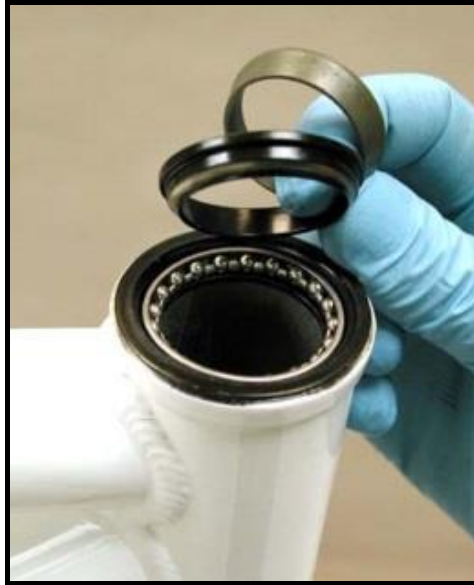
Εικόνα 7.6.3: Έδρανα Headset (συνόλου κεφαλής) ποδηλάτου, χωρίς δαχτυλίδια. Εικόνα από Park Tool 12 .
