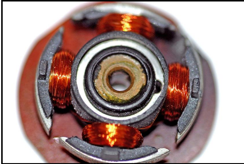
Εικόνα 8.2.1.4: Στάτωρ κινητήρα DC χωρίς ψήκτρες από ανεμιστήρα ψύξης υπολογιστή. Εικόνα από Wikimedia Commons 18 .
