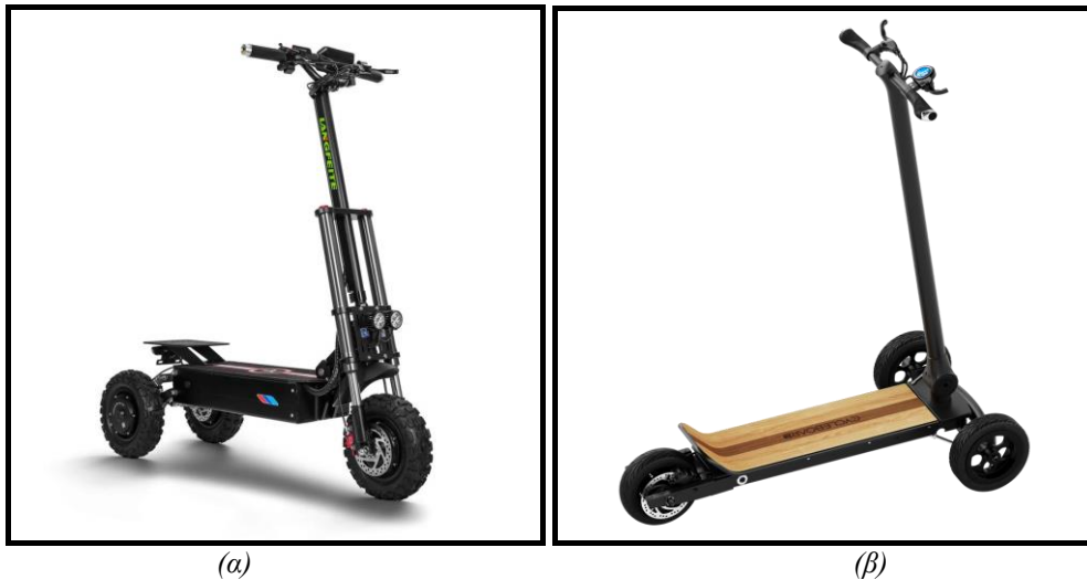
Εικόνα 4.2.2.1: (α) Ηλεκτρικό πατίνι της εταιρίας LANGFEITE, 3 κινητήρες-τροχοί. (β) Ηλεκτρικό πατίνι της εταιρίας CYCLEBOARD, ο πίσω τροχός είναι κινητήρας-τροχός.
