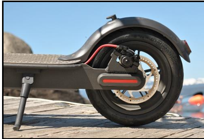
Σχήμα 8.6.1: Δισκόφρενο, μοντέλο Xiaomi Mi M365.
