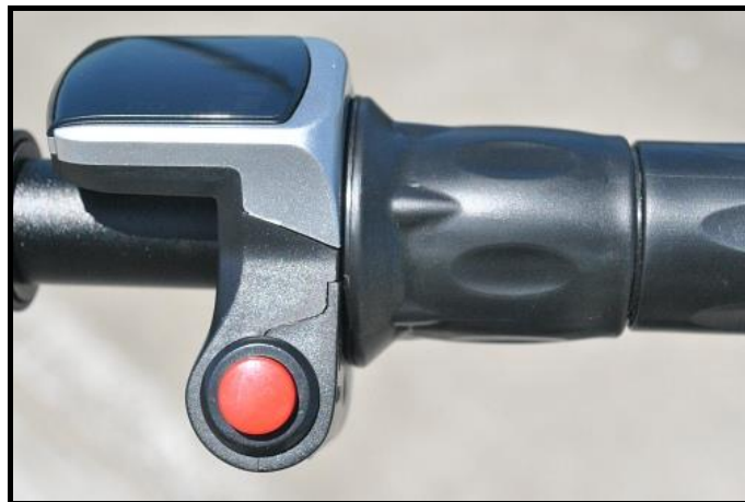
Εικόνα 4.8.7.6: Μπουτόν (κουμπί) ενεργοποίησης ηλεκτρονικού φρένου, μοντέλο Glion Dolly 225.
