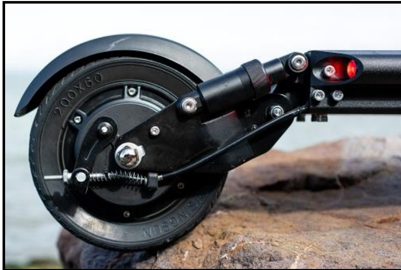
Εικόνα 4.8.7.3: Τροχός με φρένο τυμπάνου. Εικόνα από τον ιστότοπο της ESG.
