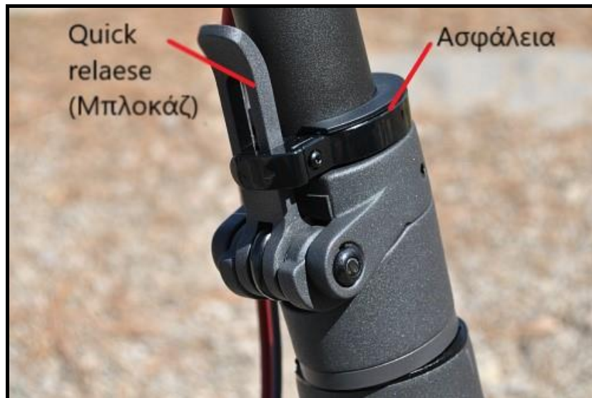
Εικόνα 6.1.4.3: Μηχανισμός εφαρμοσμένος στο στέλεχος. Μοντέλο Xiaomi Mi M365.
