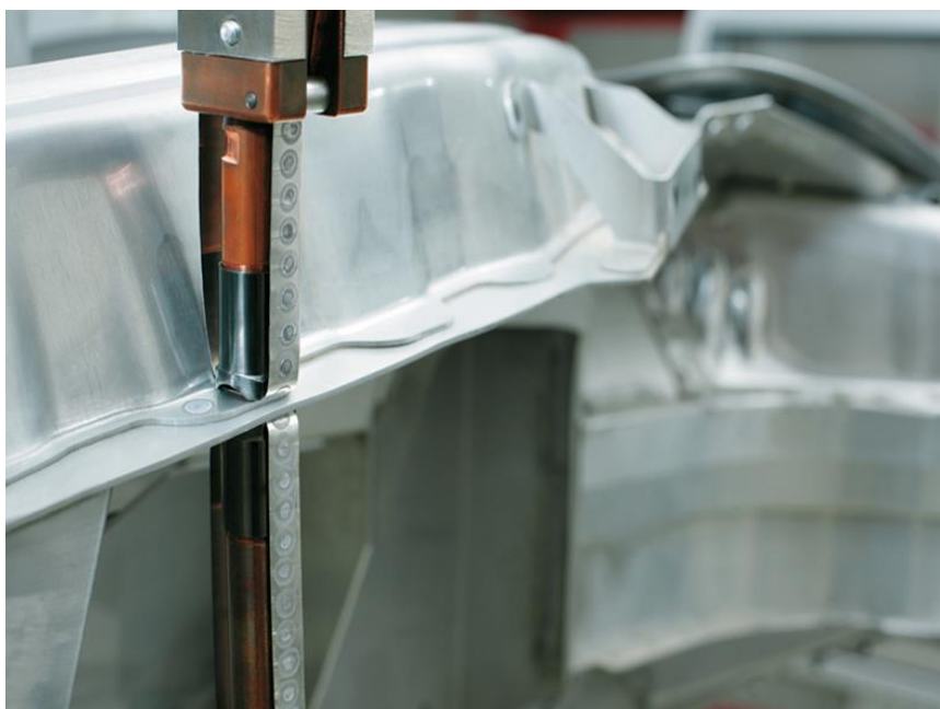
Σχήμα 8.3: Διαδικασία συγκόλλησης με αντίσταση
