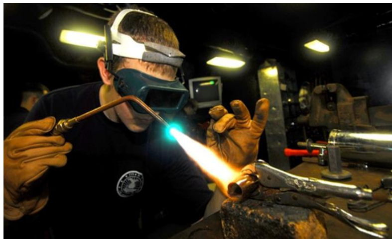
Σχήμα 8.4: Απεικόνιση απλής οξυγονοκόλλησης.
