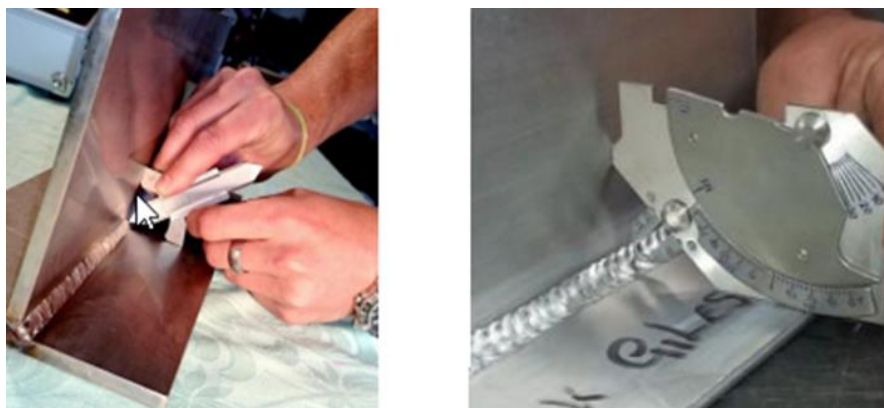
Σχήμα 8.12: Παράδειγμα μεθόδου οπτικού ελέγχου.
