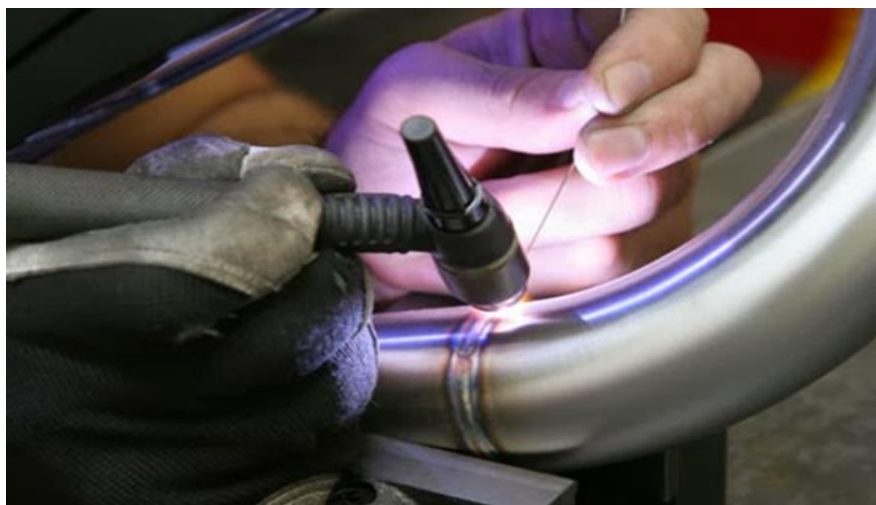
Σχήμα 8.9: Μέθοδος συγκόλλησης με T.I.G.
