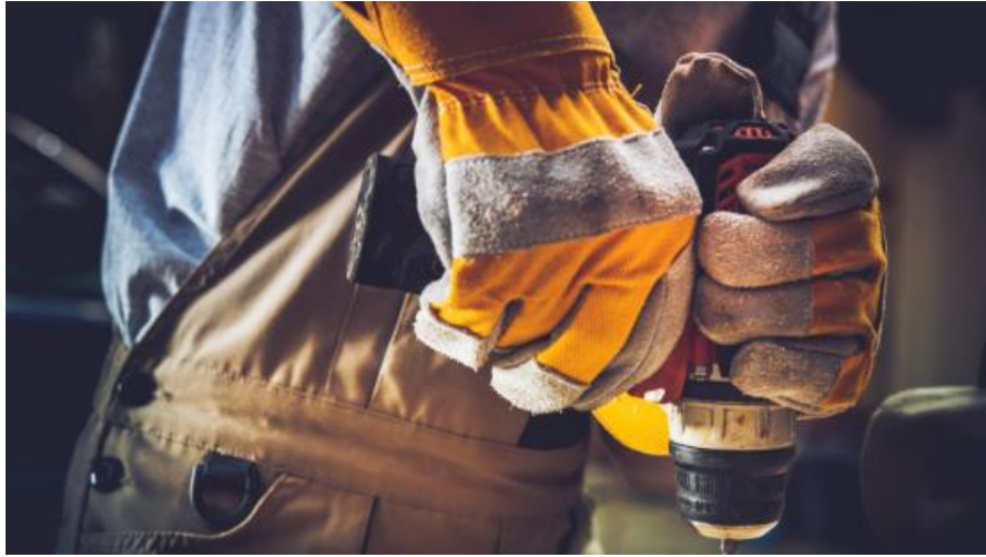
Εικόνα 3.7: Χρήση γαντιών προστασίας για εργασία με ηλεκτρικό εργαλείο χειρός.
