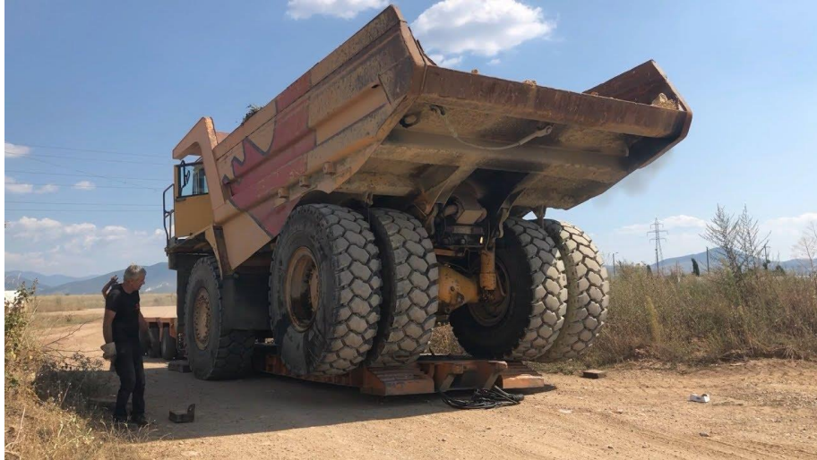
Εικόνα 2.11: Φορτηγό Dumper, σύγκριση μεγέθους με άνθρωπο. Σε εργοτάξια μικρής κλίμακας, για την μεταφορά αδρανών υλικών στην οδοποιία, συνήθως χρησιμοποιούνται ανατρεπόμενα φορτηγά μικρότερης κλίμακας αντί για φορτηγά Dumper.
