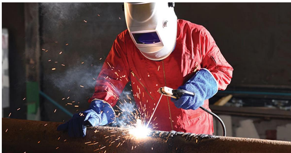
Εικόνα 3.4: Μάσκα συγκόλλησης – Ο τεχνίτης φαίνεται να τηρεί τα μέσα ατομικής προστασίας και να προστατεύει όλες τις επιφάνειες του σώματος του.
