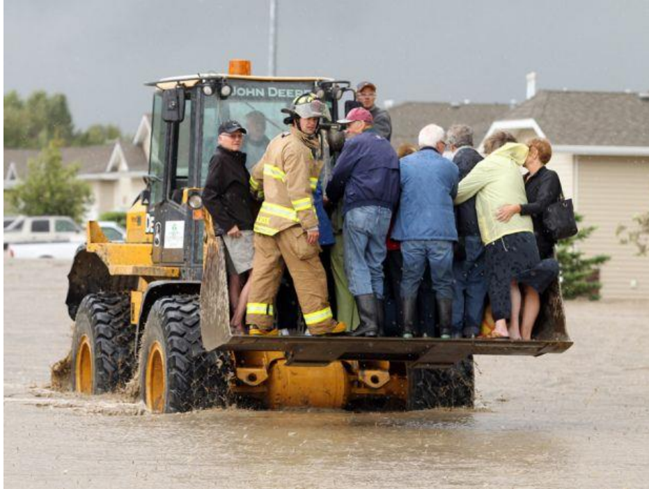
Εικόνα 2.7: Φορτωτής που εξυπηρετεί μεταφορά ανθρώπων σε πλημμύρα. Ενώ ηθικά μπορεί να φαίνεται σωστό, πρακτικά οι άνθρωποι στέκονται όρθιοι σε ένα αυτοκινούμενο χωματουργικό μηχάνημα έργου μεγάλης μάζας, χωρίς κανένα μέτρο προστασίας.
