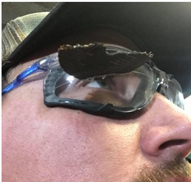
Εικόνα 3.3: Γυαλιά προστασίας - Στην εικόνα παρουσιάζεται πώς αποφεύχθηκε ατύχημα από θραύσμα γωνιακού τροχού.
