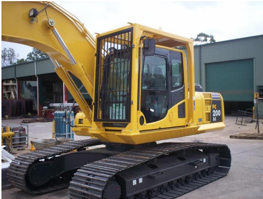
Εικόνα 2.5: Ερπυστριφόρος εκσκαφέας με σύστημα ROPS. Διακρίνεται η υπερκατασκευή που προστατεύει την καμπίνα.
