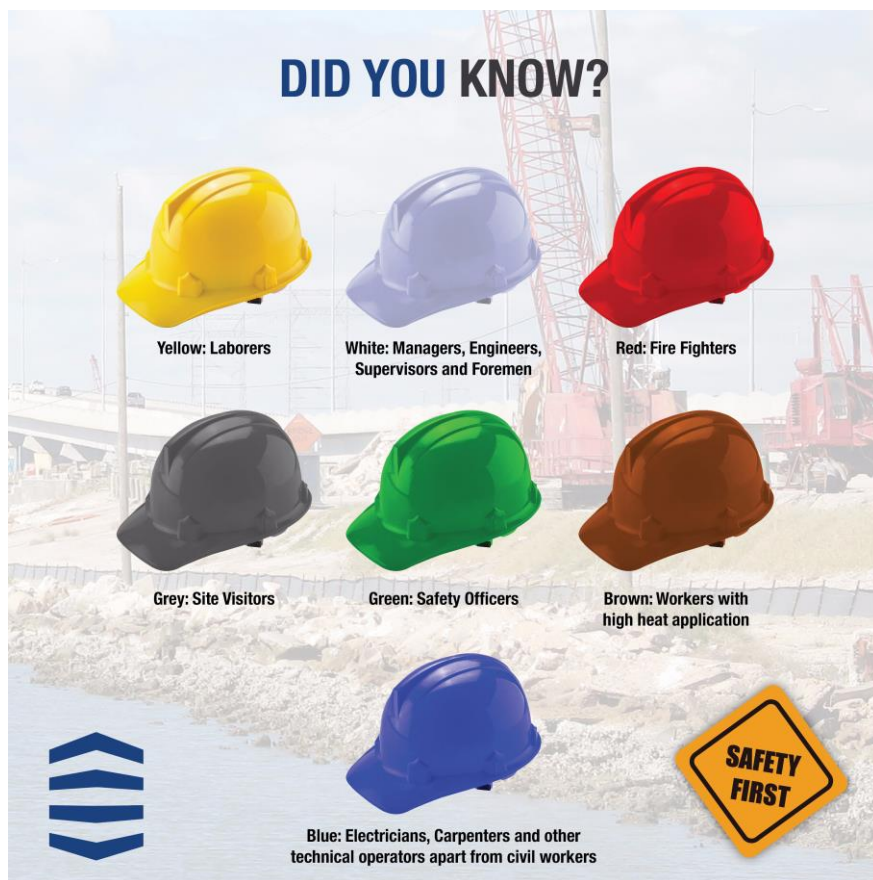
Εικόνα 3.1: Κράνη προστασίας κεφαλιού. Στην παρούσα εικόνα εμφανίζονται τα χρώματα τα οποία καθορίζουν την ειδικότητα του εργαζομένου στον χώρο του εργοταξίου.
