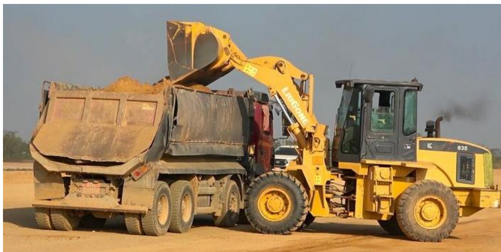
Εικόνα 2.10: Εναπόθεση αδρανών από φορτωτή σε φορτηγό
