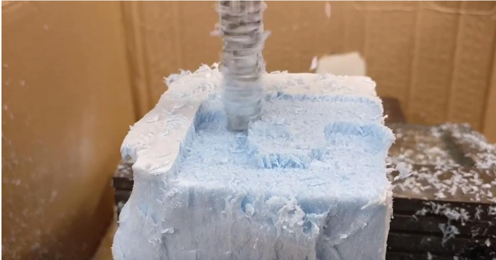
Εικόνα 50 Εκτέλεση γραμμικών κινήσεων για την κατεργασία τριών αξόνων
