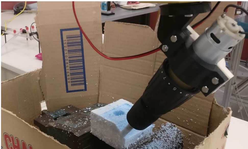
Εικόνα 53 Κατεργασία κεκλιμένης επιφάνειας κινώντας το κοπτικό στους τέσσερις άξονες κίνησης
