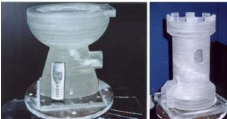
Εικόνα 22 Τεμάχια με πολύπλοκη εξωτερική αλλά και εσωτερική γεωμετρία
