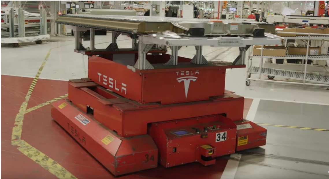
Εικόνα 2 Κινούμενο ρομπότ με ρόδες σε εργοστάσιο της Tesla. Το ρομπότ αυτό καθοδηγείται με μαγνητική ταινία στο έδαφος.
