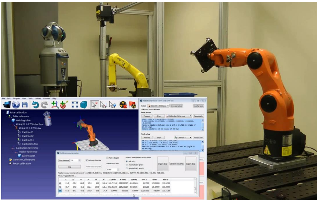
Εικόνα 27 Βαθμονόμηση ρομποτικού βραχίονα της εταιρίας KUKA με το πρόγραμμα Robo DK.
