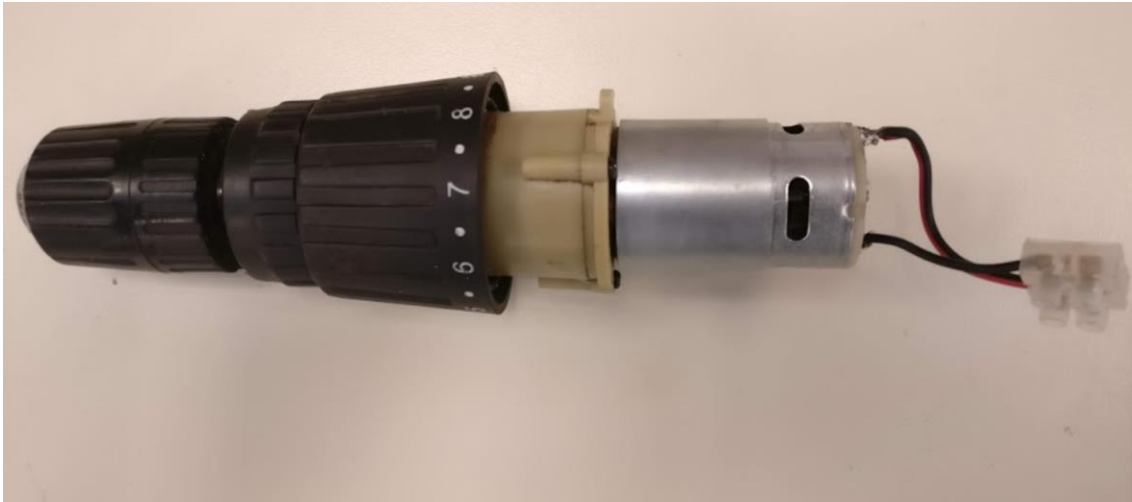
Εικόνα 29 Φωτογραφία κινητήρα επαναφορτιζόμενου τρυπανιού.
