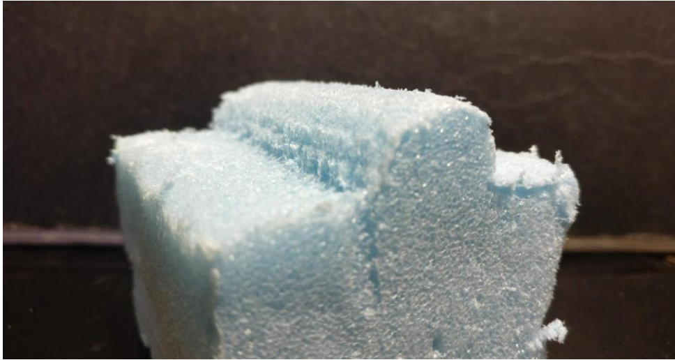
Εικόνα 59 Αποτέλεσμα κατεργασίας κεκλιμένης επιφάνειας με τη χρήση τεσσάρων αξόνων
