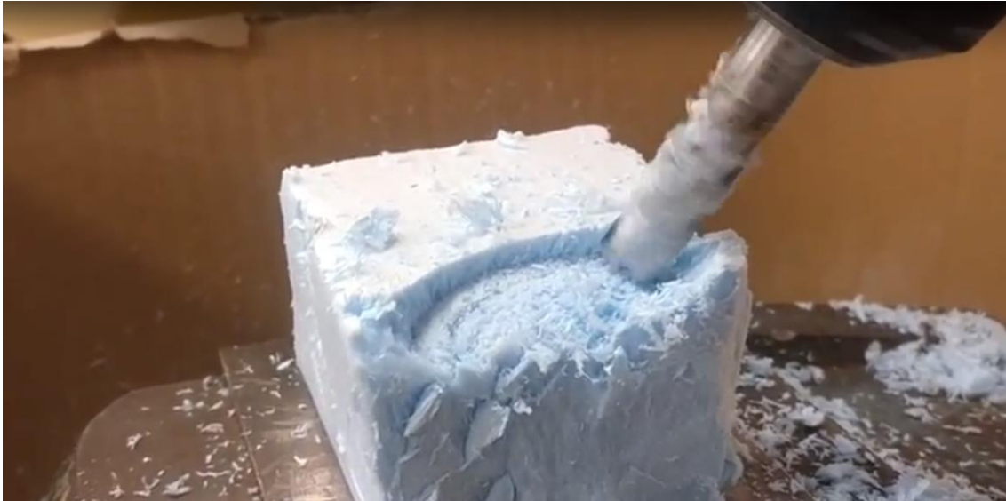
Εικόνα 54 Κατεργασία καμπύλης επιφάνειας κινώντας το κοπτικό και στους πέντε άξονες κίνησης.
