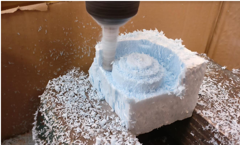
Εικόνα 51 Εκτέλεση κυκλικών κινήσεων για κατεργασία τριών αξόνων
