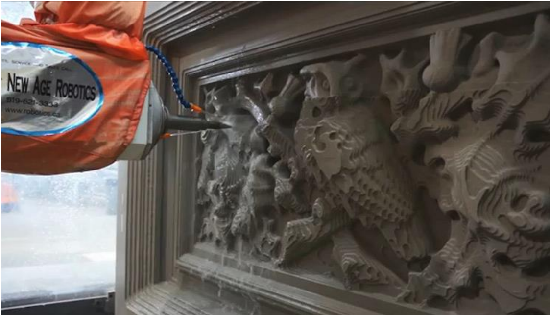
Εικόνα 21 Γλυπτική πέτρας με τη χρήση ρομποτικού βραχίονα
