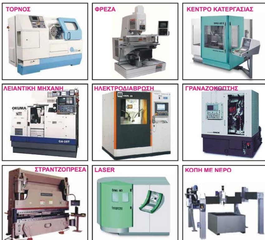
Εικόνα 14 Διαφορετικοί τύποι ψηφιακά καθοδηγούμενων εργαλειομηχανών.
