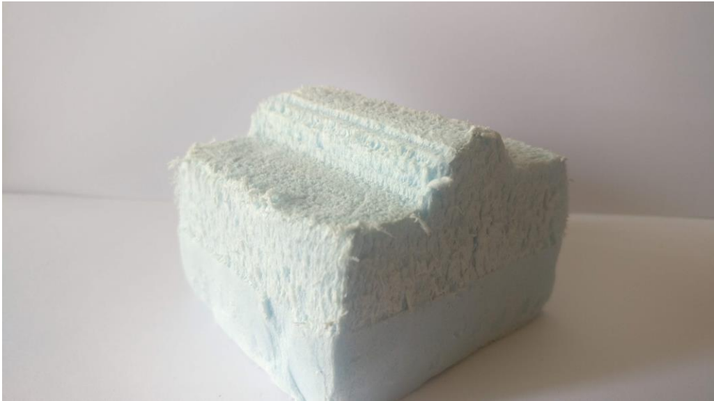
Εικόνα 55 Αποτελέσματα κατεργασίας τριών αξόνων .
