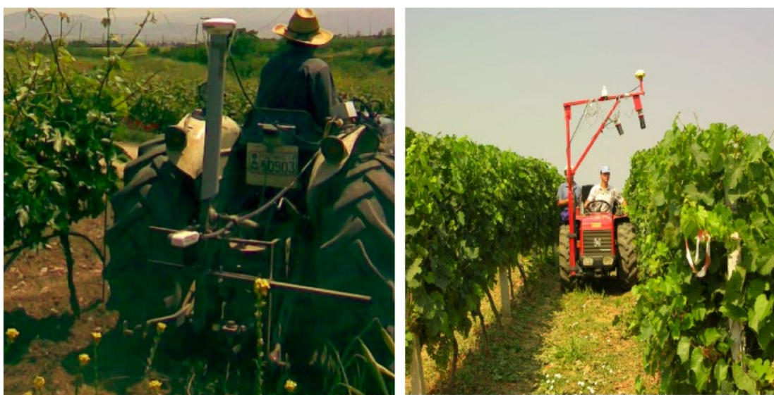
Εικόνα 12: Αισθητήρες φυλλώματος σε γεωργικό ελκυστήρα πλευρικά της φυλλικής επιφάνειας (αριστερά) και πάνω από τη φυλλική επιφάνεια (δεξιά) (Κουνδουράς, 2015).
