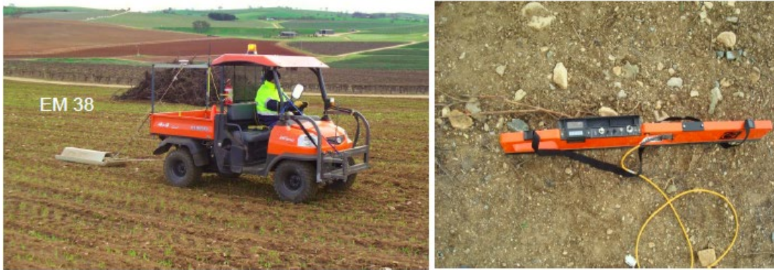
Εικόνα 14: Χρήση αισθητήρα EM-38 σε γεωργικό ελκυστήρα και χειρωνακτικά (Koundouras, 2014).
