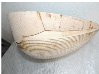
Εικόνα 11: Σκάφος μπουζουκιού κατασκευασμένο από σφεντάμι
