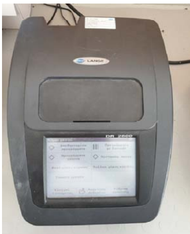
Σχήμα 3.7 φωτόμετρο HACK LANGE LT-200
