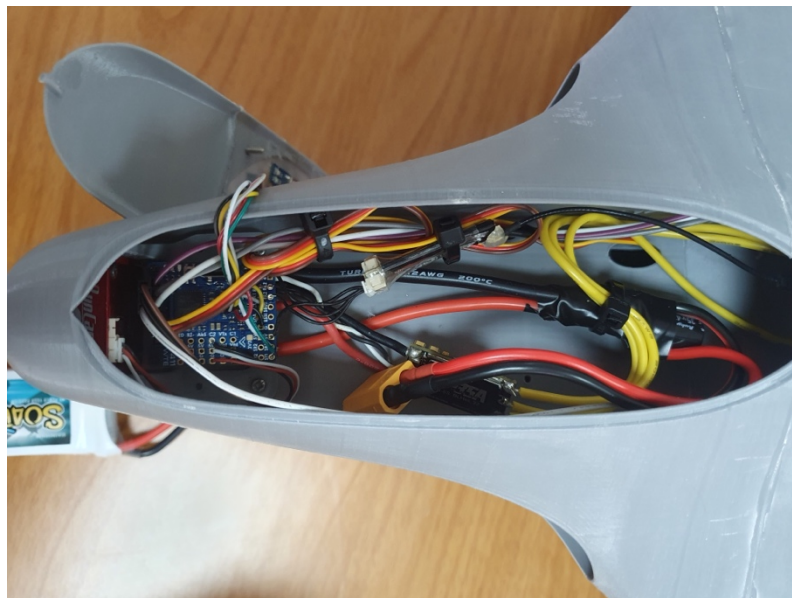
Εικόνα 61. Τοποθέτηση FC στο αεροσκάφος
