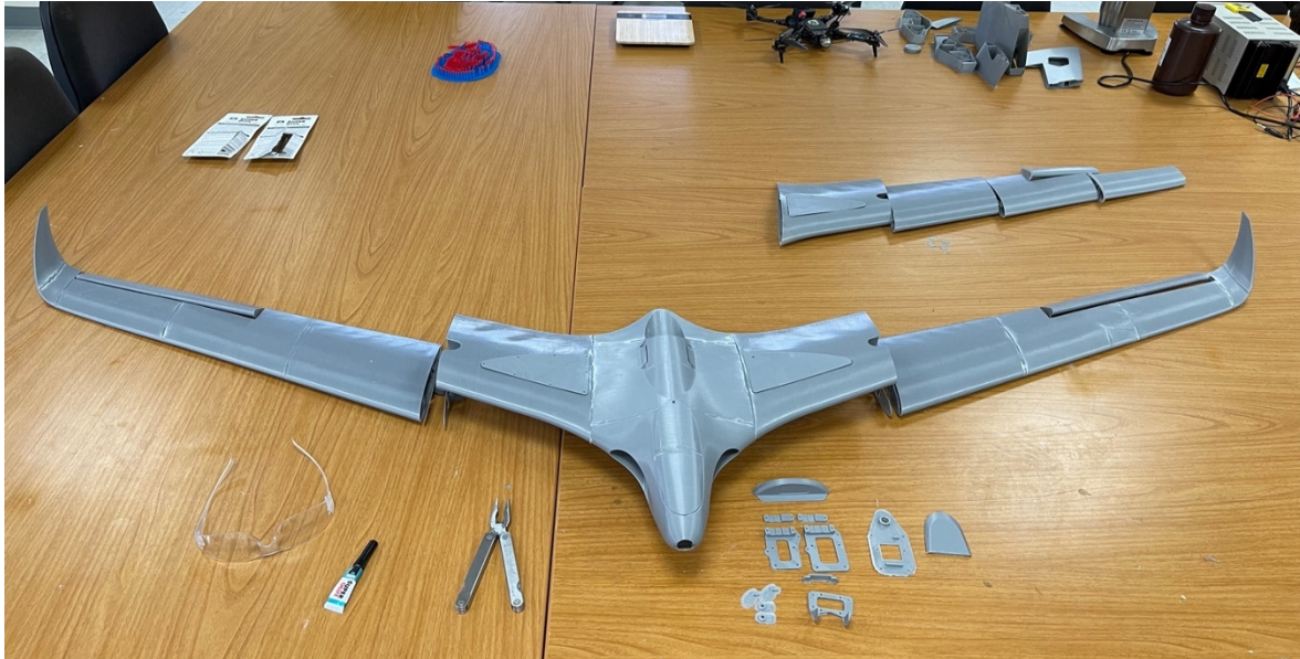
Εικόνα 30. Τα 3 βασικά μέρη του Αεροσκάφους
