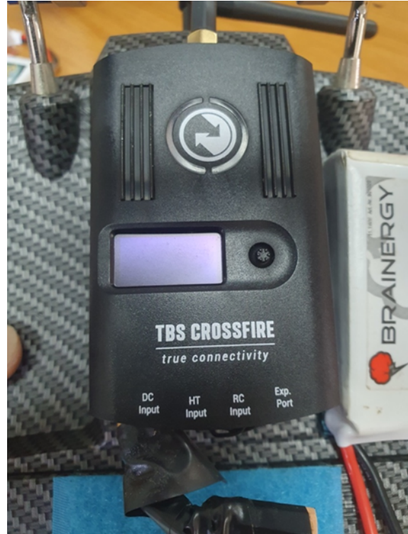
Εικόνα 65. Μονάδα Επέκτασης ραδιοσήματος TBS Crossfire
