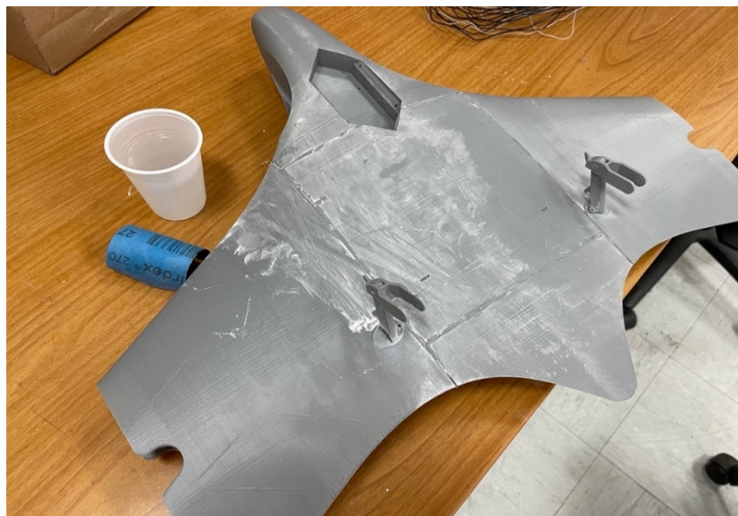
Εικόνα 27. Λείανση κεντρικού μέρους του αεροσκάφους
