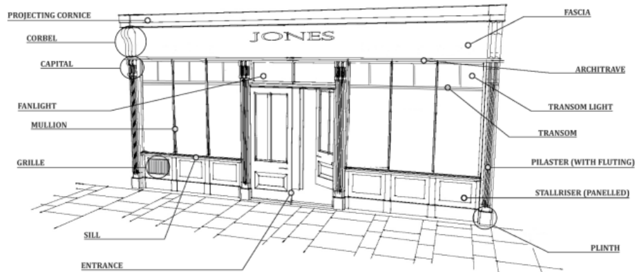
Εικόνα 35: Γενικά εξωτερικά στοιχεία (Πηγή: democracy.brent.gov.uk).
