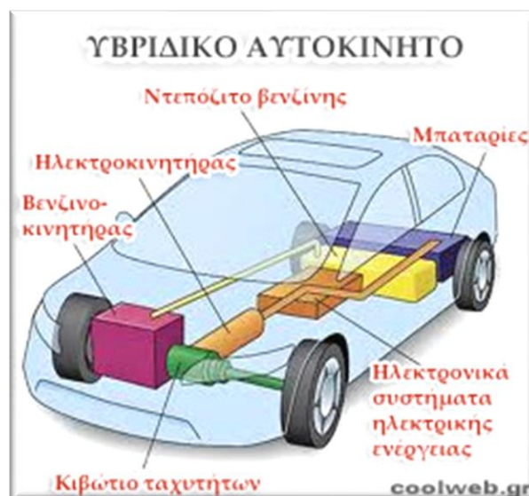
Εικόνα 3.3.3.β Τα βασικά μηχανολογικά μέρη ενός υβριδικού αυτοκινήτου
