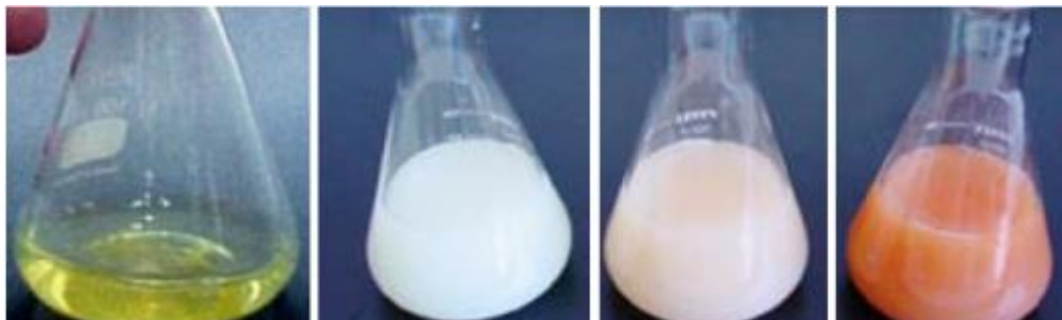
Εικόνα 13: Αριστερά βλέπουμε το χρώμα του αρχικού δείγματος παρουσία δείκτη και την σταδιακή αλλαγή κατά τη διάρκεια της ογκομέτρησης μέχρι το τελικό ισοδύναμο σημείο. (6)
