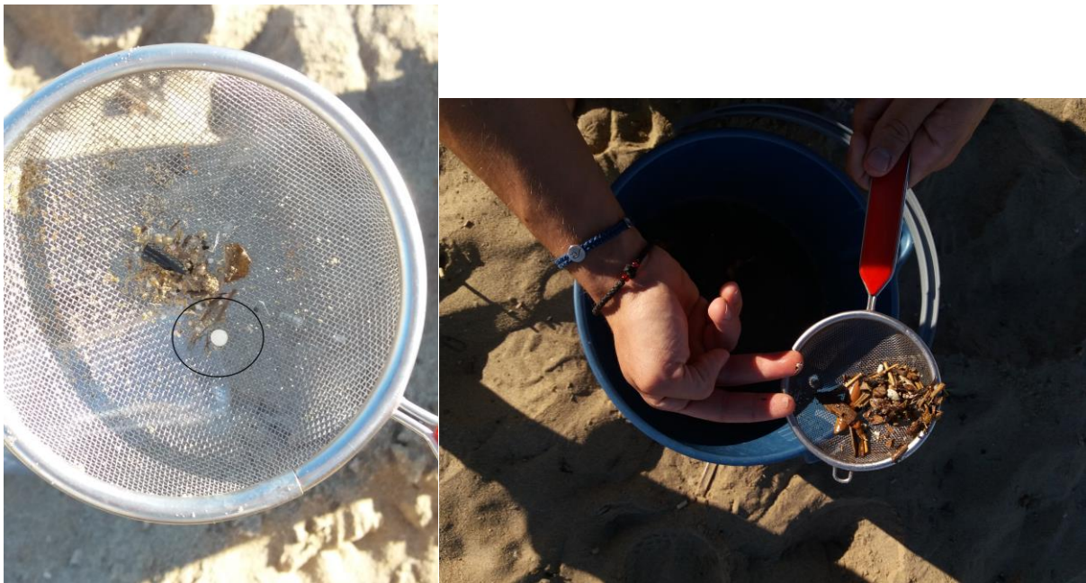
Εικόνες 6.11 και 6.12. Απεικόνιση το τρόπου συλλογής των μικροπλαστικών και της οργανικής ύλης από την επιφάνεια του νερού έκπλυσης της άμμου. Στην αριστερή εικόνα φαίνεται καθαρά η ύπαρξη ενός μικροπλαστικού (επισημασμένο σε μαύρο κύκλο).
