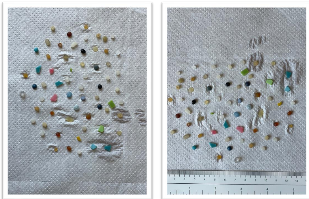
Εικόνες 6.13 και 6.14: Απεικόνιση των μικροπλαστικών αφού έχουν ξεπλυθεί, μετά τον οπτικό διαχωρισμό τους από την υπόλοιπη επιπλέουσα οργανική ύλη.
