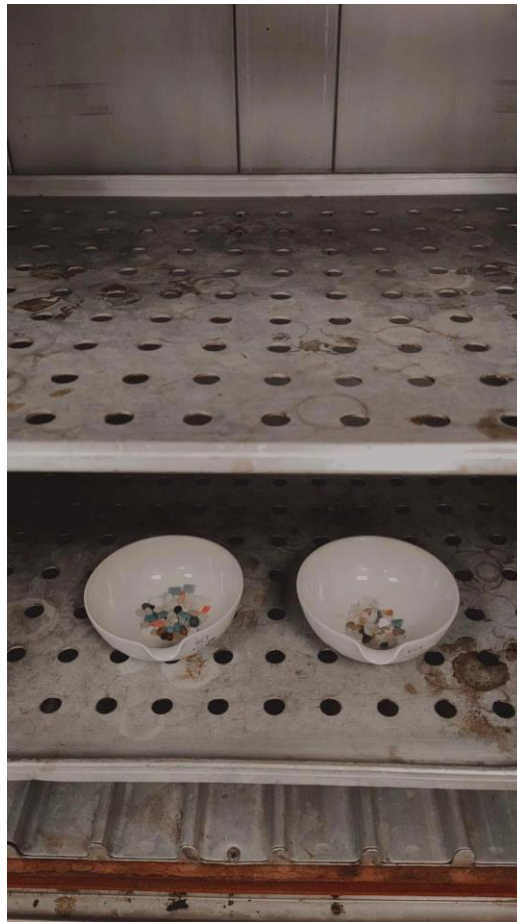
Εικόνα 6.15: Απεικόνιση των μικροπλαστικών μέσα σε κάψες στον φούρνο ξήρανσης για 24 ώρες στους 103°C.
