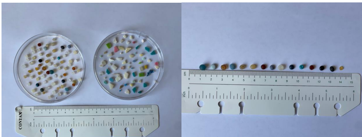
Εικόνες 6.18 και 6.19: Αριστερή φωτογραφία: Ταξινόμηση μικροπλαστικών με οπτικό διαχωρισμό των τύπων των μικροπλαστικών σε πλαστικόσφαιρες (αριστερό δείγμα) και θραύσματα (δεξιό δείγμα). Δεξιά φωτογραφία: Μέτρηση της μεγαλύτερης διάστασης και επίδειξη των διαφορετικών μεγεθών συλλεχθέντων μικροπλαστικών.
