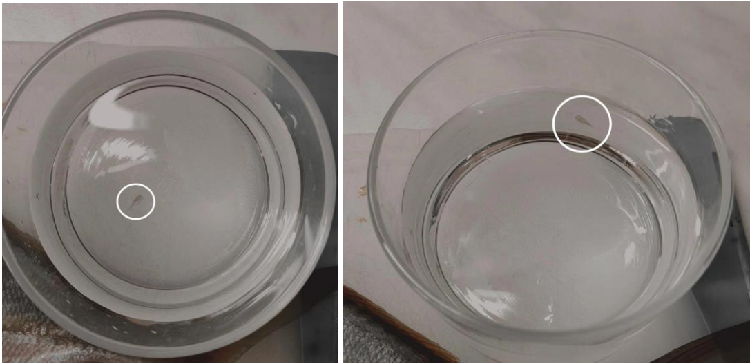
Εικόνες 7.5 και 7.6 : Απεικόνιση του μικροπλαστικού μέσα σε νερό για να εξακριβωθεί η ταυτότητα του με την μέθοδο της διαφοράς της πυκνότητας.
