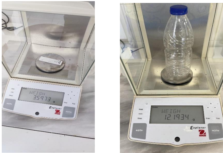
Εικόνα 2.6 : Εργαστηρικές μετρήσεις μάζας αριστερά ενός COVID -19 test και δεξιά μίας πλαστικής φιάλης όγκου 0,5L (με καπάκι και χωρίς ετικέτα) σε αναλυτικό ζυγό.
