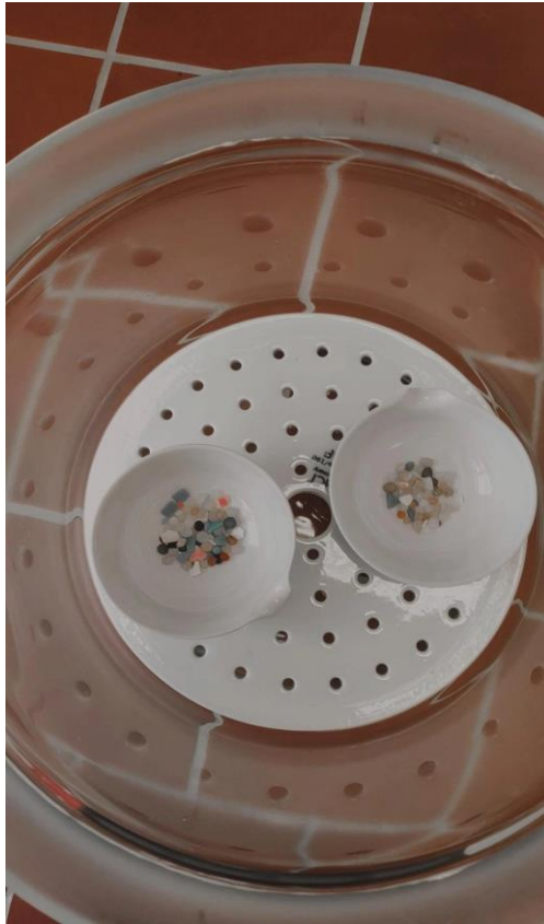
Εικόνα 6.16: Απεικόνιση των ξηραμένων μικροπλαστικών σε ξηραντήρα κενού, έτσι ώστε να ψυχθούν σε θερμοκρασία δωματίου πριν ζυγιστούν.
