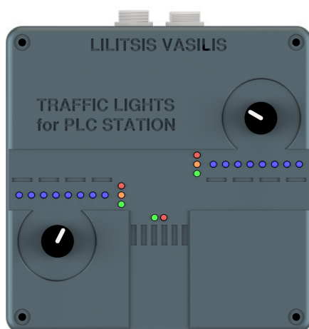
Εικόνα 3.8: Άνω όψη του τρισδιάστατου μοντέλου του εξομοιωτή διασταύρωσης
