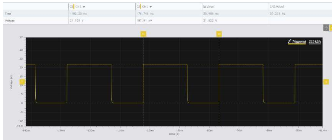
Εικόνα 3.4: Κυματομορφή μέγιστης συχνότητας εξόδου
