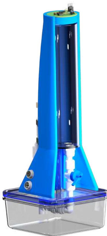
Εικόνα 4.17: Τρισδιάστατο σχέδιο εξομοιωτή δεξαμενής
