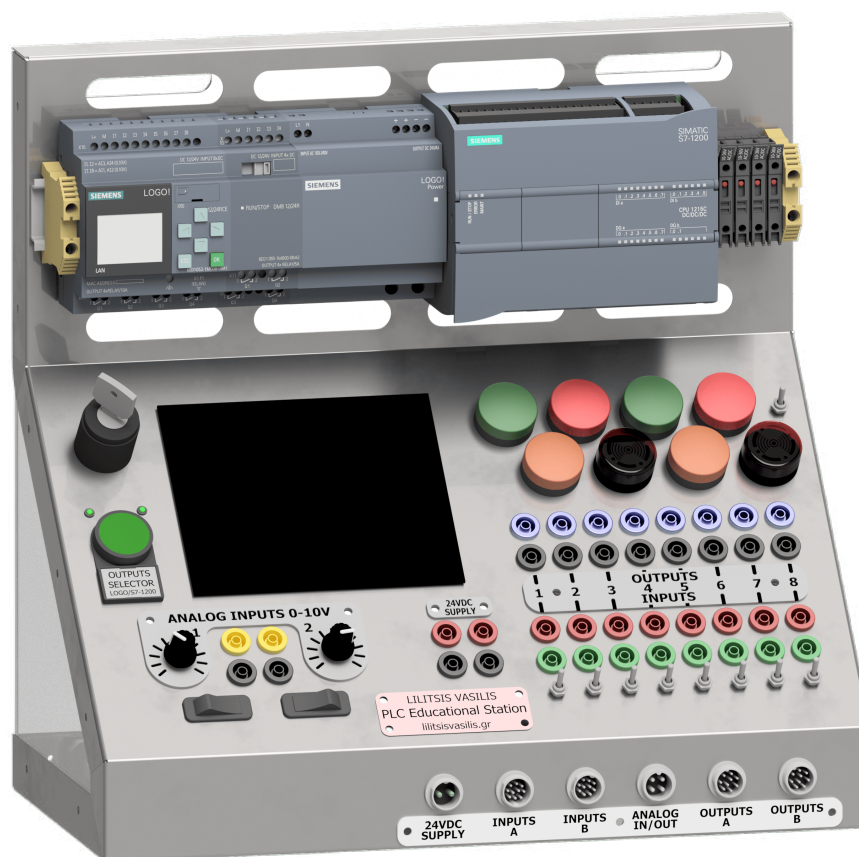
Εικόνα 2.2: Τρισδιάστατο σχέδιο αναπαράστασης του σταθμού εκπαίδευσης PLC
