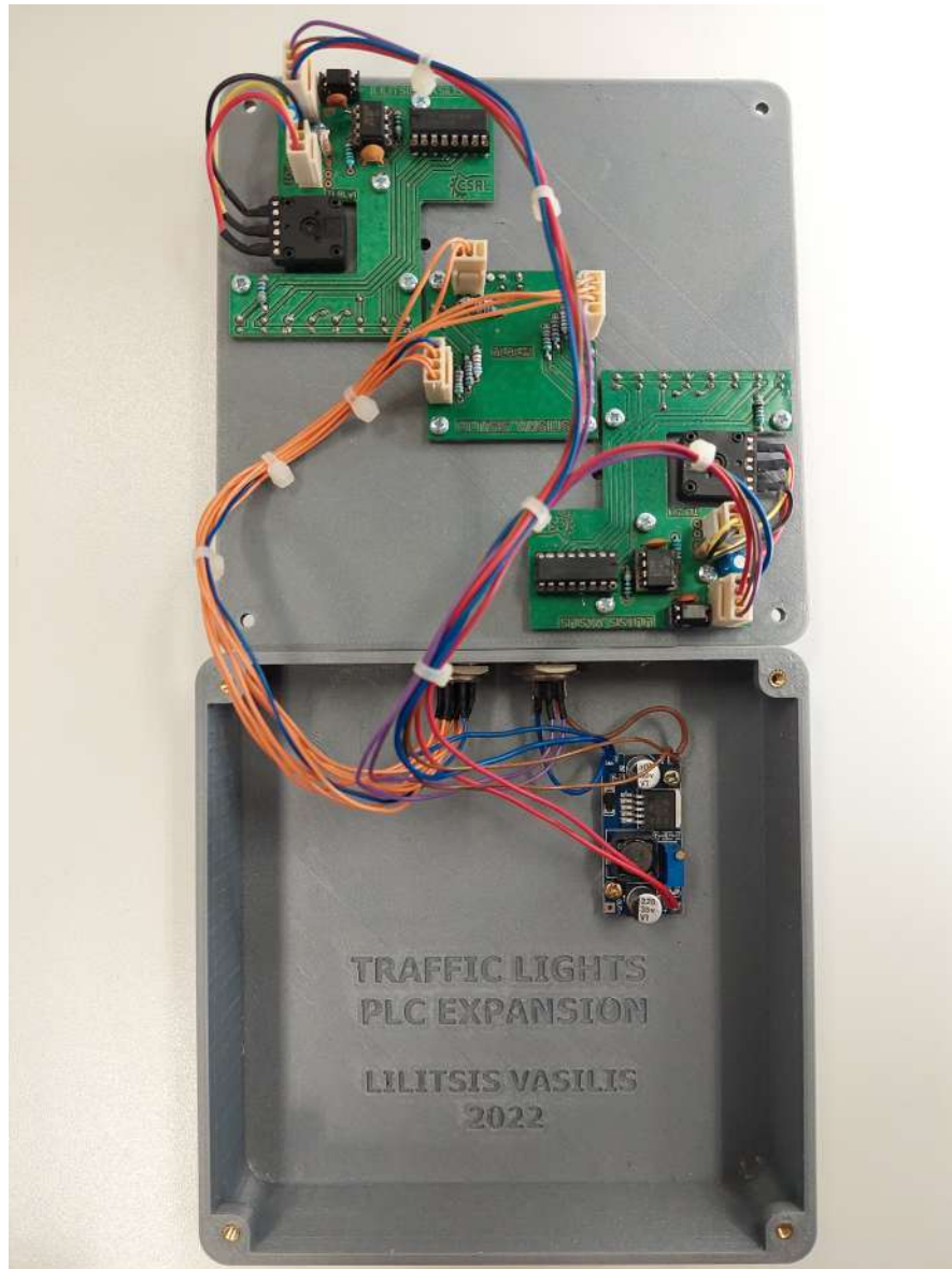
Εικόνα 3.14: Ολοκληρωμένη διάταξη και συνδεσμολογία του εξομοιωτή διασταύρωσης
