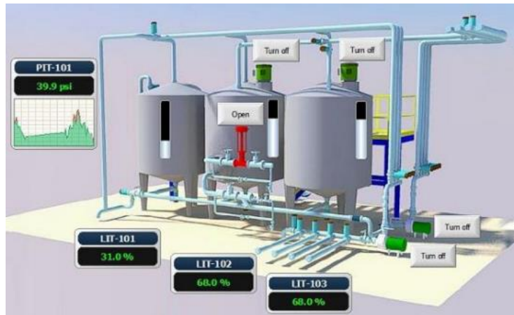
Εικόνα 43 Οπτικοποίηση ελέγχου δεξαμενής μέσω συστήματος SCADA
