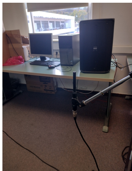
Σχήμα 1.6_ Ηλεκτροακουστική διάταξη για την οποία μετρήθηκε η κρουστική απόκριση. (Εργαστήριο Εφαρμοσμένης Ακουστικής, Τμήμα Μουσικής Τεχνολογίας και Ακουστικής.)
