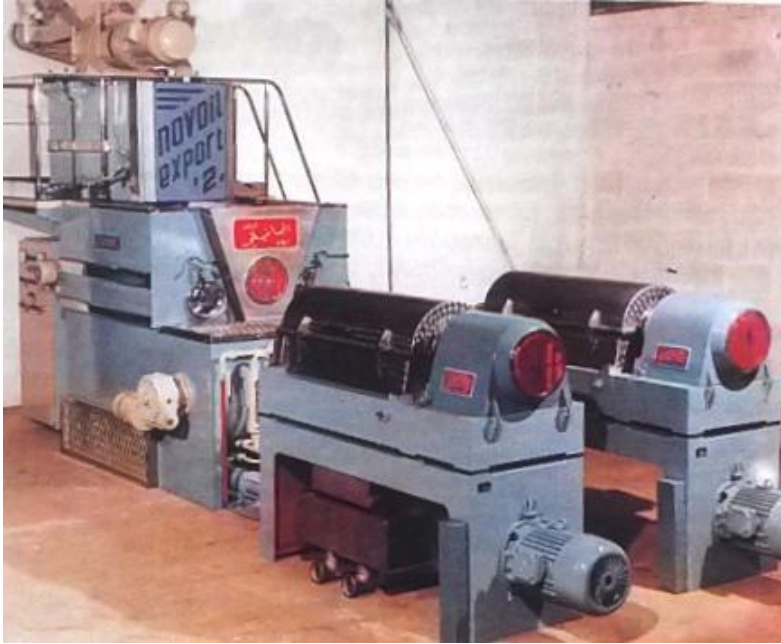
Εικόνα 2-11 Πλήρες μικτό ελαιουργικό συγκρότημα με μονάδα Sinolea και Decanter (Κυριτσάκης Α. , 2007, σ. 215).
