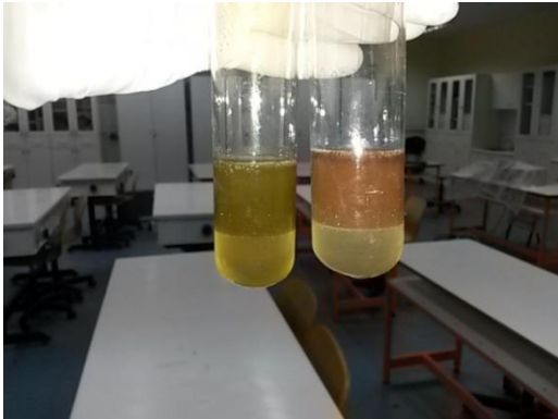
Εικόνα 6-5 Το ελαιόλαδο (αριστερά) εμφανίζει το λαδοκίτρινο χρώμα, αντίθετα με το ηλιέλαιο (δεξιά) που εμφανίζει καφέ χρώμα.
