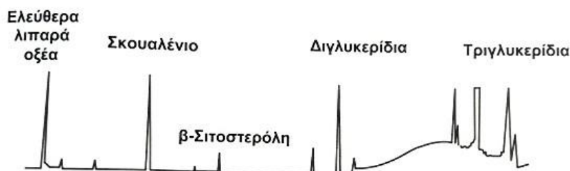
Εικόνα 6-9 Αεριοχρωματογραφικός διαχωρισμός ελεύθερων λιπαρών οξέων, διγλυκεριδίων και άλλων συστατικών του ελαιολάδου (Κυριτσάκης Α. , 2007, σ. 571).
