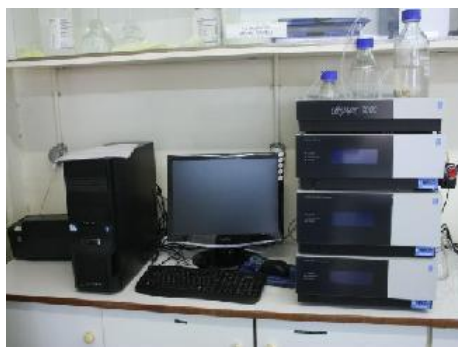
Εικόνα 8-22 Τυπική εργαστηριακή διάταξη χρωματογραφίας HPLC (του οίκου Dionex) (Καρκαλούσος & Τσότσου, 2015, σ. 230).
