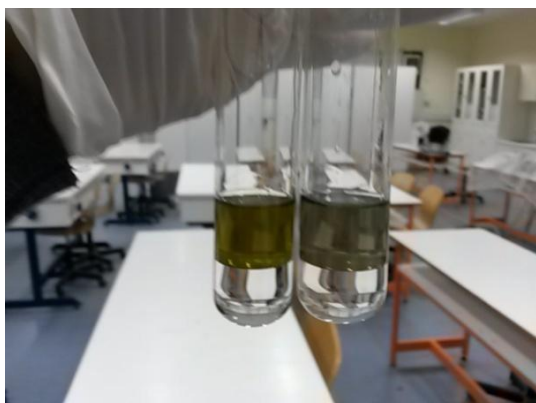
Εικόνα 6-4 Αριστερά το ελαιόλαδο δεξιά το ηλιέλαιο μετά την προσθήκη του πυκνού νιτρικού οξέος.
