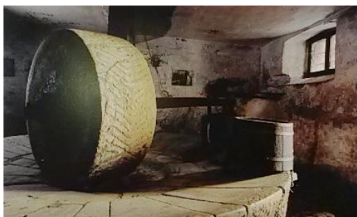
Εικόνα 2-1 Παραδοσιακός ελαιόμυλος με κυλινδρική μυλόπετρα (Κυριτσάκης Α. , 2007, σ. 186).
