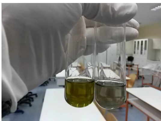
Εικόνα 6-3 Αριστερά το ελαιόλαδο δεξιά το ηλιέλαιο μετά τη διήθηση.
