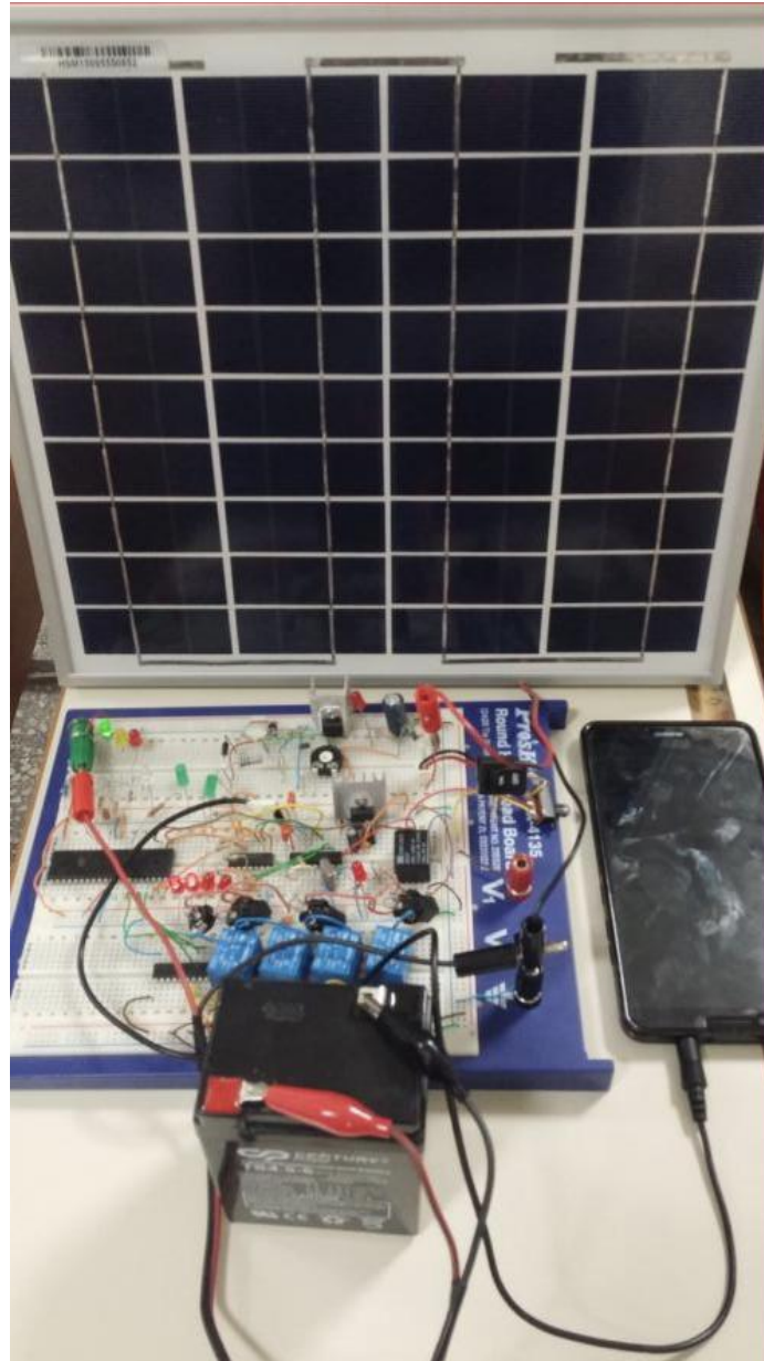
Εικόνα 2.8: Τελικό Κύκλωμα Φόρτισης Μπαταρίας με Φωτοβολταϊκό Πάνελ
