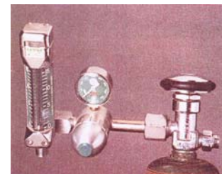
Εικόνα 4.2: Ροόμετρο, στερεωμένο σε μεγάλη φιάλη οξυγόνου, που επιτρέπει τη ρυθμιζόμενη ροή από 0-15 λίτρα το λεπτό.[7]
