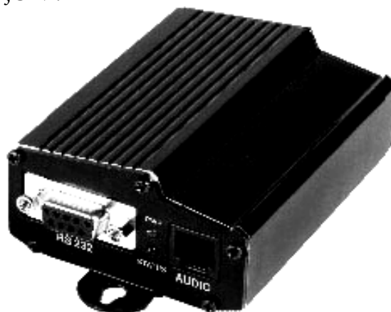
Σχημα.2.2. Το GSM μόντεμ TER-GX101S της Round Solutions που χρησιμοποιήθηκε στο σύστημα.
