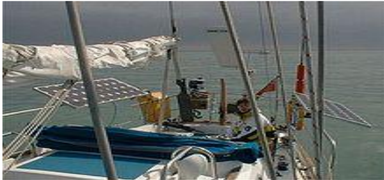
Εικόνα 2-68 Φ/Β πάνελ σε βάρκα για τροφοδότηση της με ηλεκτρική ενέργεια ( http://en.wikipedia.org/wiki/Photovoltaics_in_transport , 18-5-2010)
