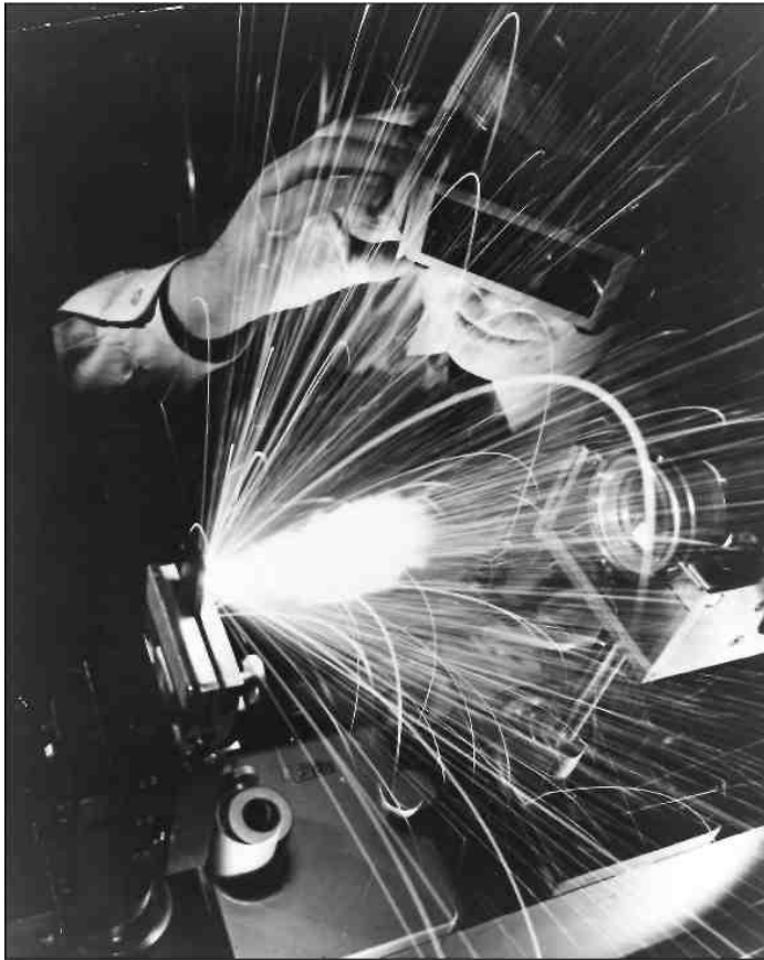
Ένας τεχνικός χρησιμοποιεί λέιζερ για να κόψει τις τρύπες στο χάλυβα άνθρακα, μία από τις σκληρότερες τεχνητές ουσίες.
