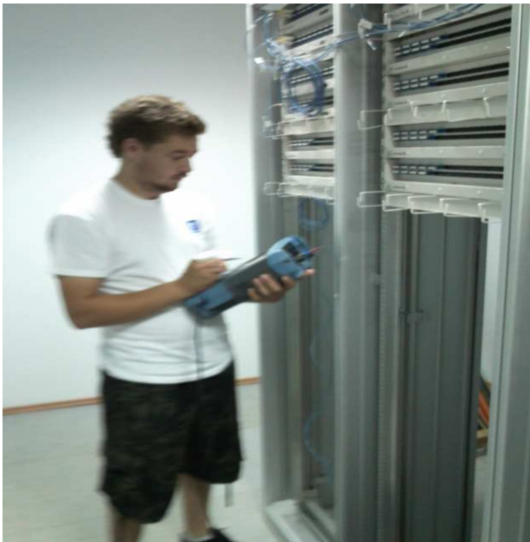
Σχήμα 3.19 : Μέτρηση με OTDR
