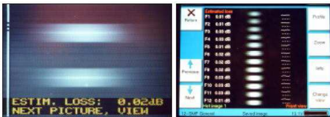
Σχήμα 3.3: Δυο εικόνες ηλεκτρονικής σάρωσης. Η εικόνα στα αριστερά έχει ληφθεί κατά τη διάρκεια της fusion κόλλησης μιας ίνας, ενώ η εικόνα στα δεξιά έχει ληφθεί κατά την αντίστοιχη διαδικασία για μια κορδέλα 12 ινών. Ο πυρήνας παρουσιάζεται ως μια φωτεινή περιοχή στο μέσο της ίνας.
